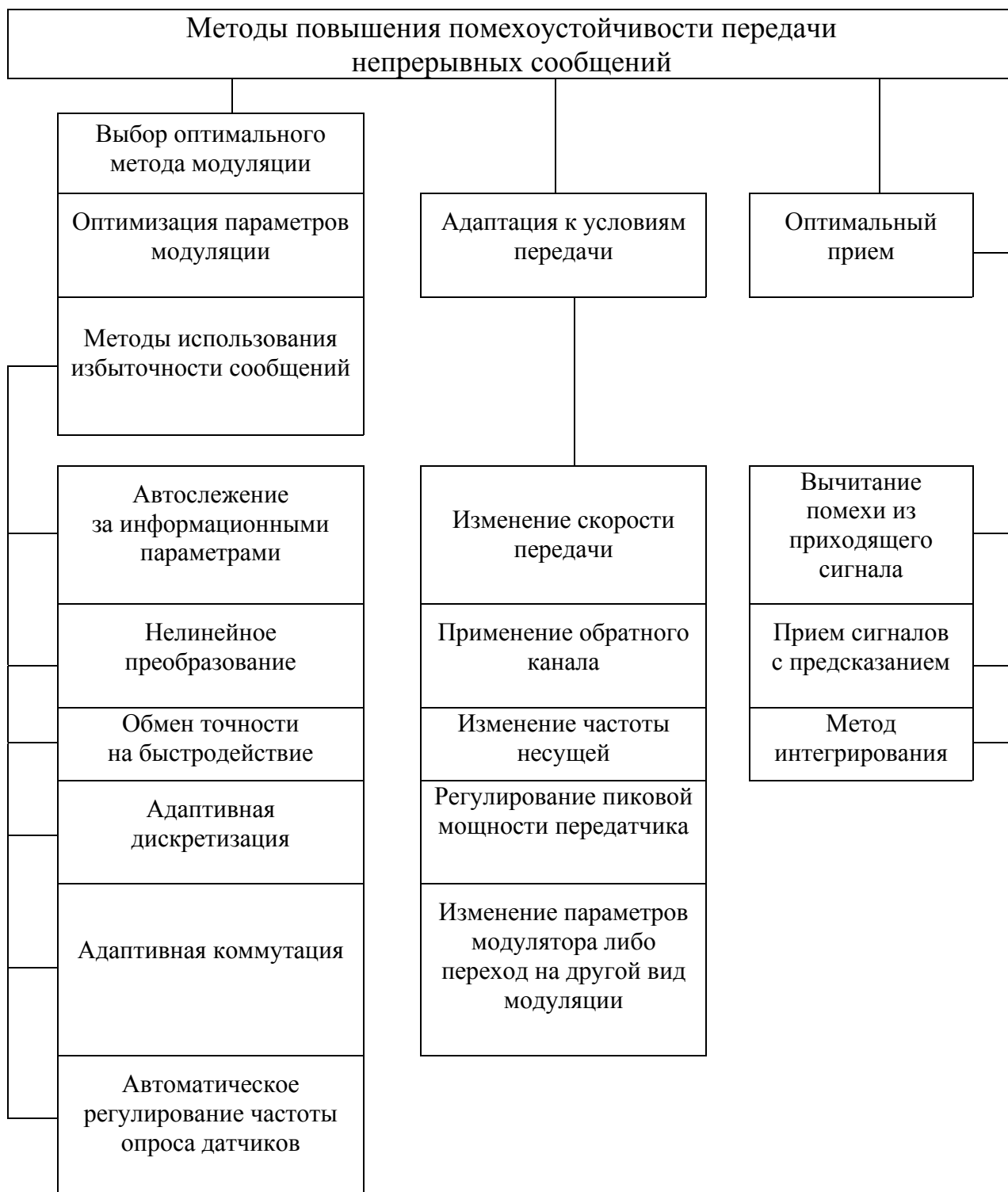
Рис. 5.2. Методы повышения помехоустойчивости передачи непрерывных сообщений
