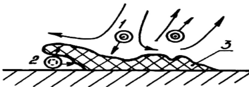
Рис. 9.3. Схема отслоения пленок загрязнений: 1,2 – захлопывающийся и пульсирующий пузырьки, 3 – пленка
