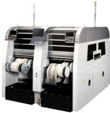
Рис. 6.11. Автомат установки компонентов Samsung SM-310
