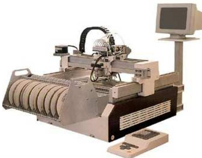
Рис. 6.10. Автомат монтажа чип-компонентов ЭМ-4425
