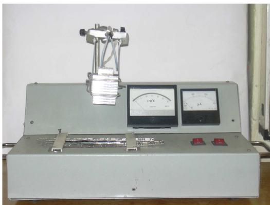
Рис. 7.4. Внешний вид установки ИК-пайки
