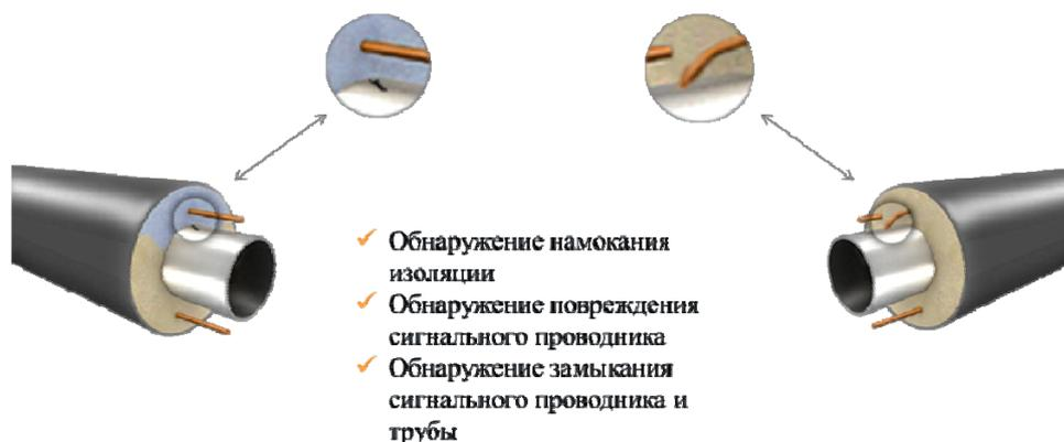
Рис. 1. Дефекты, которые позволяет обнаружить система СОДК
