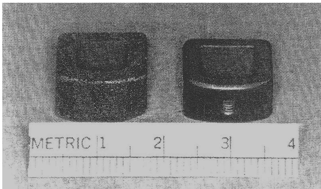
Рисунок 1 – Имплантаты позвонков, полученные методами порошковой металлургии: слева – пористый танталовый (изготовитель фирма «Sofamor Danek», США); справа - титановый беспористый (изготовитель - фирма «Allendale», США)
