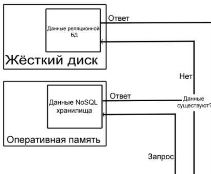
Рисунок 1 – Схема работы NoSql хранилища с реляционной БД
