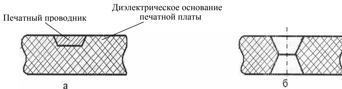
Рис 4.4. Элементы рельефной платы: а – печатный проводник; б – отверстие
