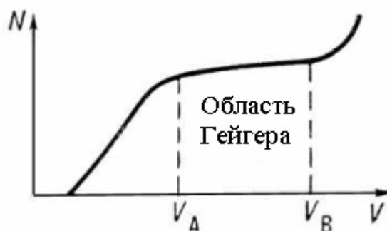
**Рис. 4. Счетная характеристика счетчика Гейгера-Мюллера**
