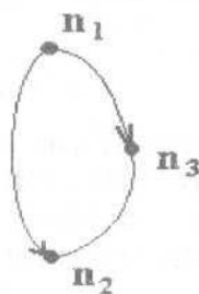
Рис. 4. К иллюстрации установления направленности ребер графа; сопротивления транзисторов, находящихся в открытом состоянии, образующих указанные связи, равны 2 между узлами n_1 и n_2 и по 1 между n_1 и n_3 и n_3 и n_2 .
