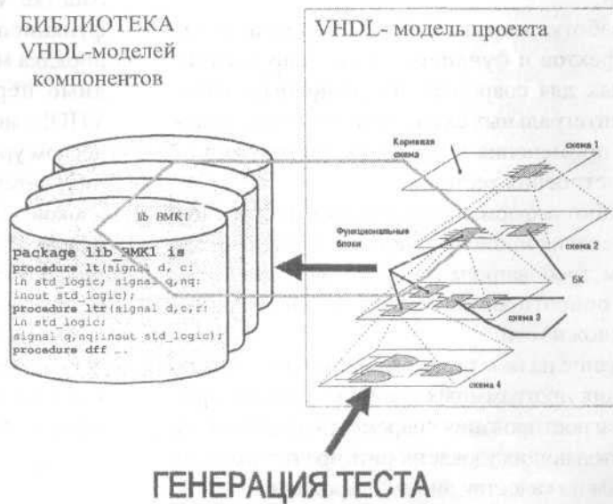
Рис.3. Общая схема реализации процесса VHDL - моделирования
