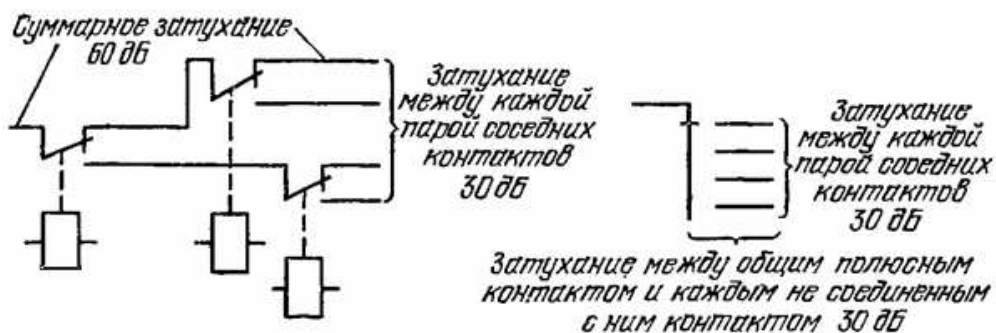
Рис. 7.22. Уменьшение перекрестных помех с помощью коаксиальных однополюсных переключающих реле
