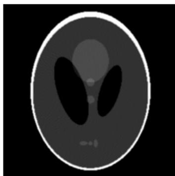
Рисунок 4.13 – Реконструкция фантома по 90 проекциям проекций с помощью веерных лучей
