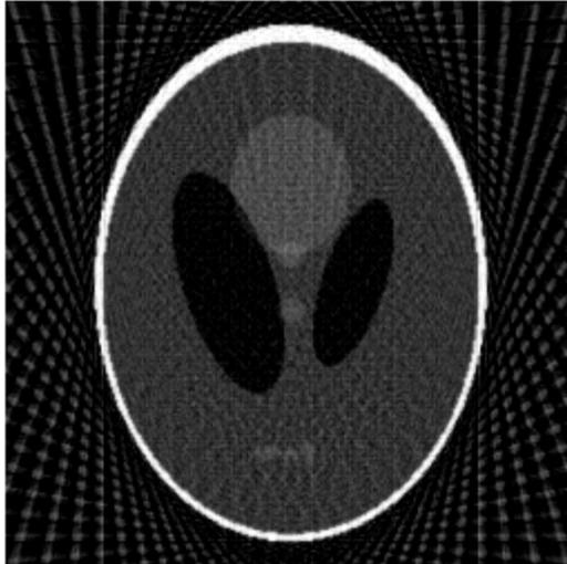
Рисунок 4.9 – Реконструкция фантома по 36 проекциям проекций с помощью параллельных лучей
