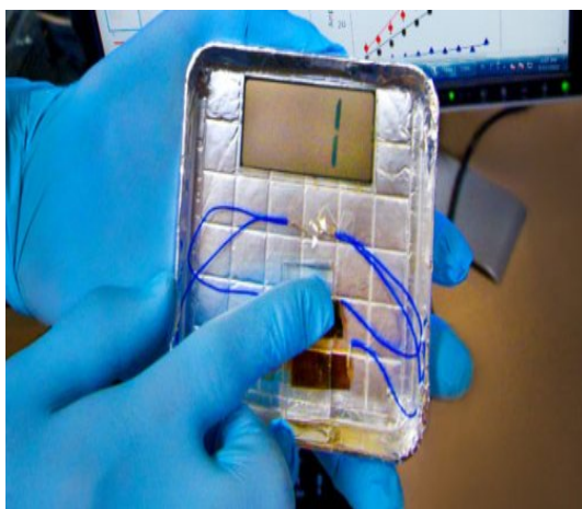
Рис. 2 – Демонстрационное устойчивое устройство аккумулятора с использованием архей
