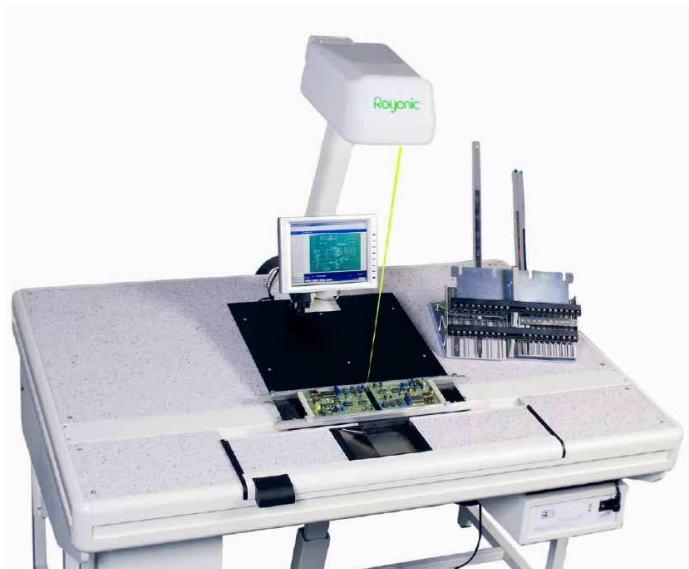
Рисунок 4.5 – Светомонтажный стол ROYONIC 712
