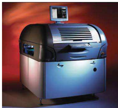
Рисунок 4.8 – Автомат трафаретной печати HORIZON
