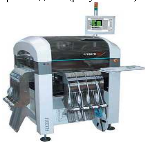
Рисунок 4.22 – Многофункциональный автомат FLX2011
