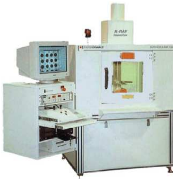
Рисунок 4.13 – Установка рентгеновского контроля CR Technology CRX-2000
