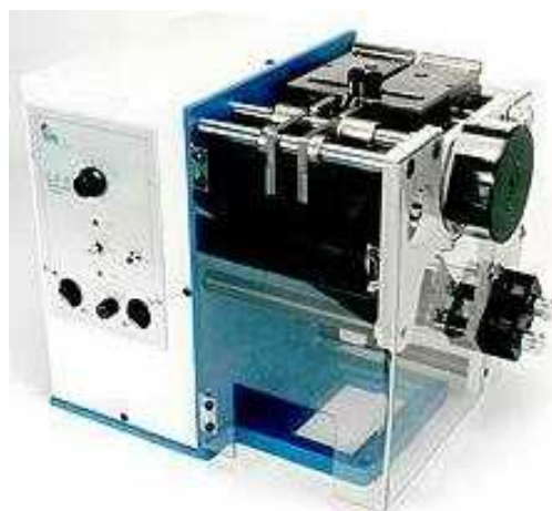
Рисунок 4.2 – Формовщик компонентов GPD CF-15
