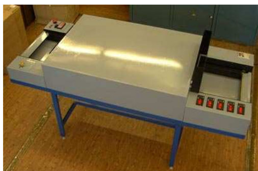
Рисунок 4.24 – Установки ИК пайки «Радуга-21» (а) и Omni Flex (б)
