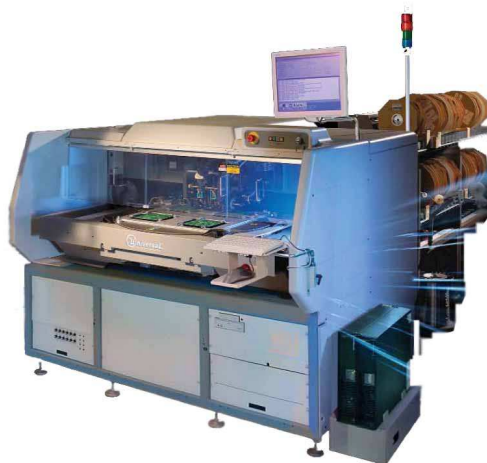
Рисунок 4.4 – Автомат-секвенсор модели 6380B RADIAL 8XT
