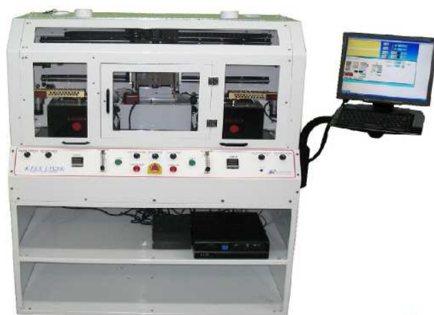
Рисунок 4.3 – Автомат лужения выводов в азотной среде KISS-LTS-200
