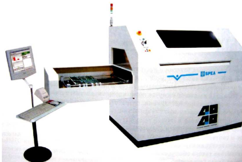
Рисунок 4.15 – Система электрического контроля SPEA 4040
