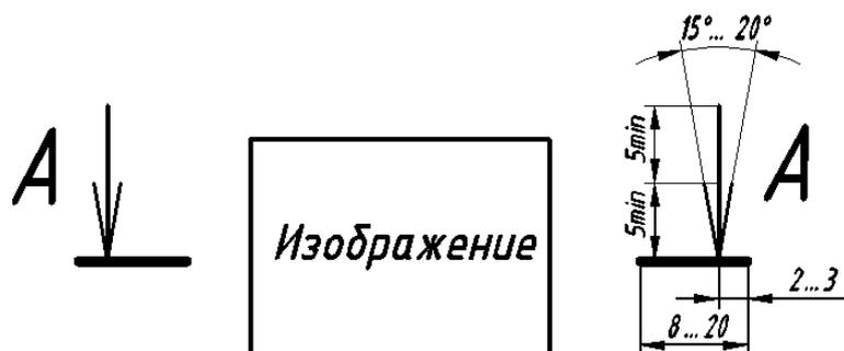
Рис. 21. Структура обозначения положения секущей плоскости
