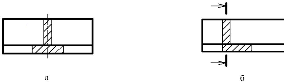
Рис. 39. Наложенные сечения
