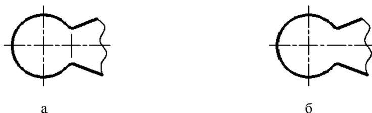
Рис. 45. Упрощения при изображении плавного перехода поверхностей
