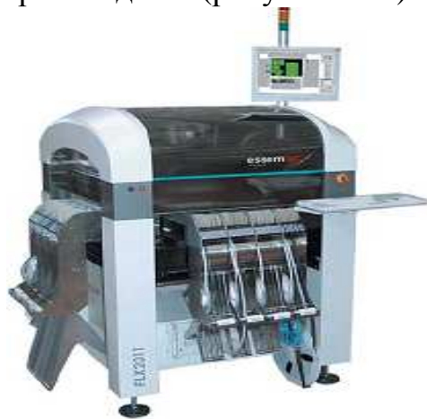
Рисунок 4.22 – Многофункциональный автомат FLX2011
