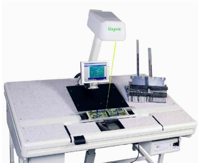
Рисунок 4.5 – Светомонтажный стол ROYONIC 712
