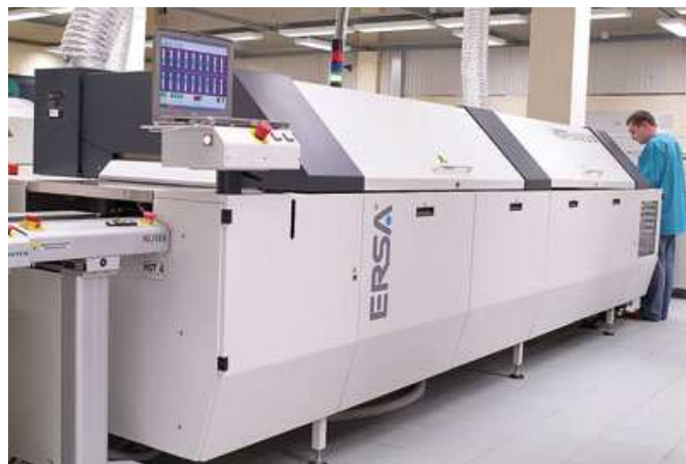
Рисунок 4.12 – Конвейерная печь конвекционного оплавления Hotflow 2/14
