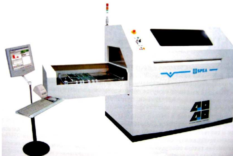
Рисунок 4.15 – Система электрического контроля SPEA 4040
