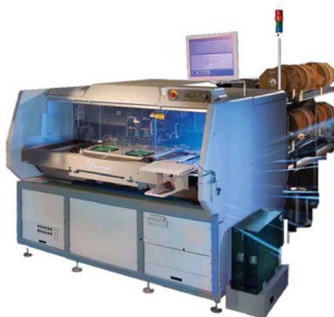
Рисунок 4.4 – Автомат-секвенсор модели 6380B RADIAL 8XT
