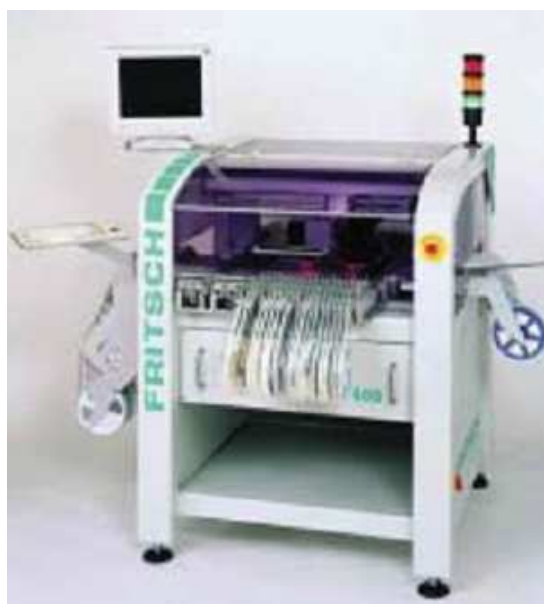
Рисунок 4.10 – Автомат установки компонентов Place ALL600
