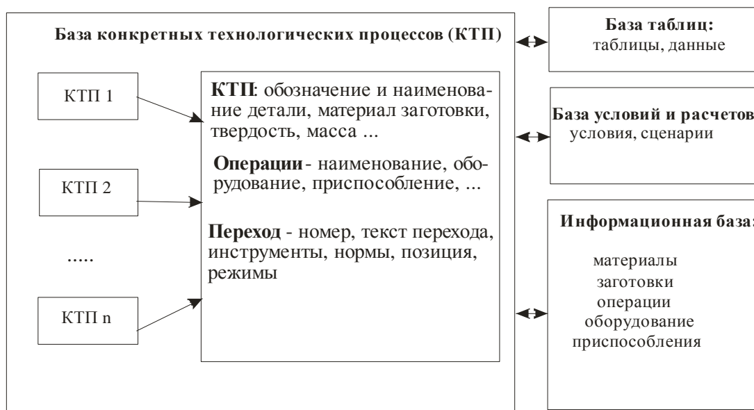
Рисунок 3.9 – Информация, используемая пользователем при диалоговом проектировании технологических процессов
