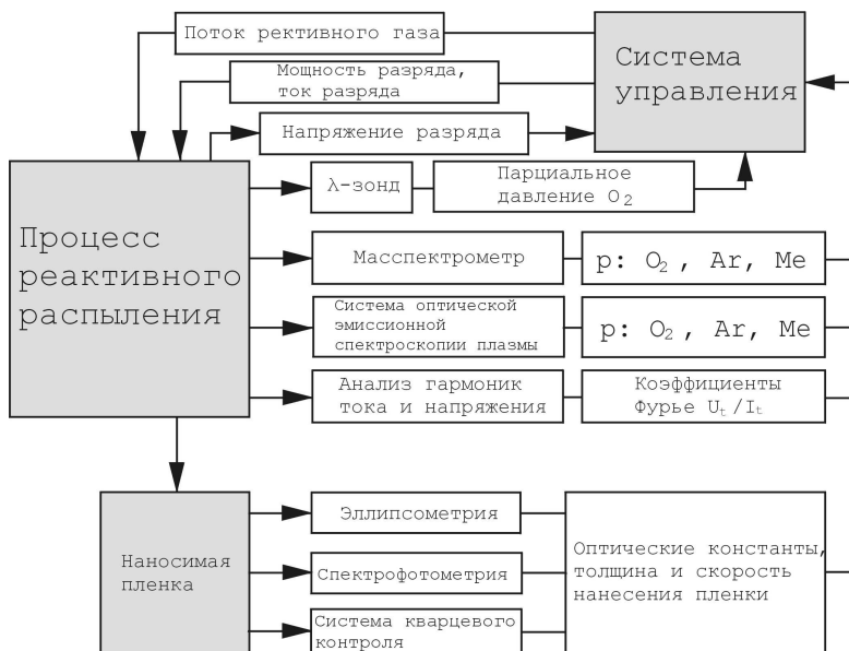
Рисунок 2.4 – Методы активного управления процессом реактивного распыления
