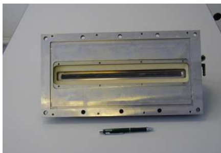
б Фотография разрядной камеры плазменного источника электронов.
