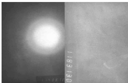
Рисунок 7.12 – Электроннограмма пленки собственного окисла арсенида галлия
