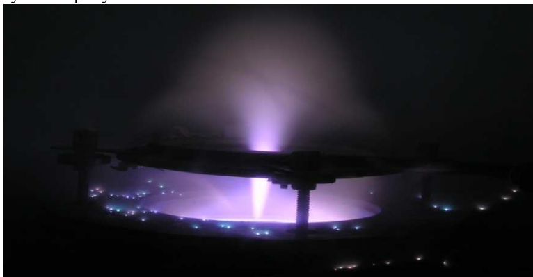
Рисунок 5.10 – Ионный пучок, сформированный из ионно-пучкового фокуса
