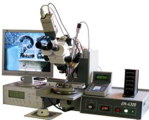
Рис.10.9. Установка сварки ЭМ-4320
