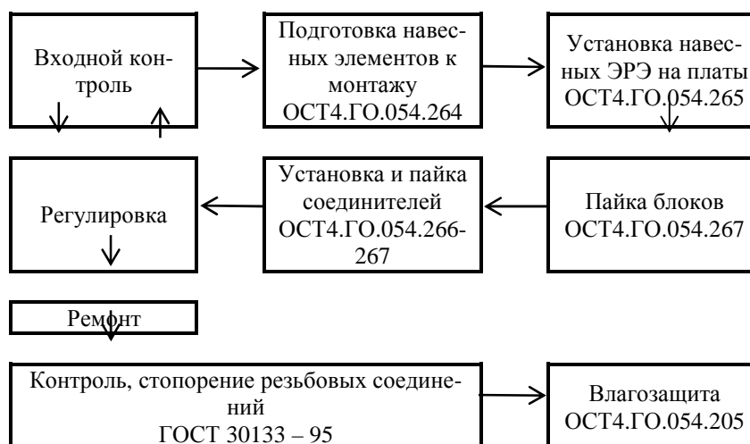
Рис. 9.1. Схема типового процесса сборки блоков на ПП
