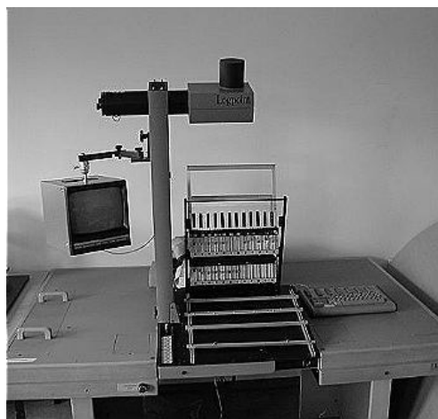
Рис. 9.15. Стол с гибкой программой сборки: 1 – дисплей; 2 – проектор; 3 – панель; 4 – накопитель; 5 – микроЭВМ; 6 – кассетница для нестандартных элементов и плат
