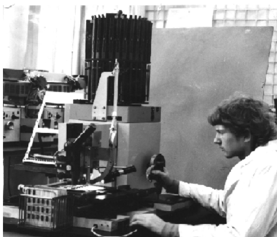
Рис. 9.16. Установка ИМС на полуавтомате с пантографом
