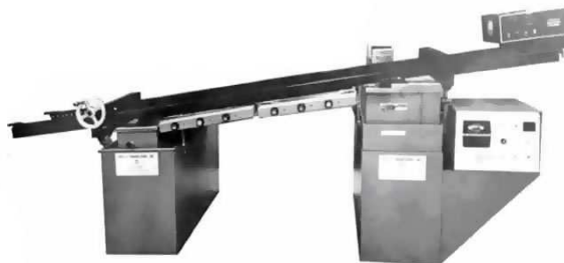
Рис. 10.5. Установка пайки TDC фирмы Hollis Engineering Inc.
