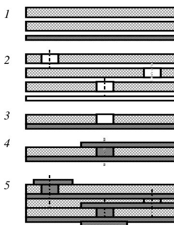
Рис. 5.29. Стадии формирования МПП методом послойного наращивания
