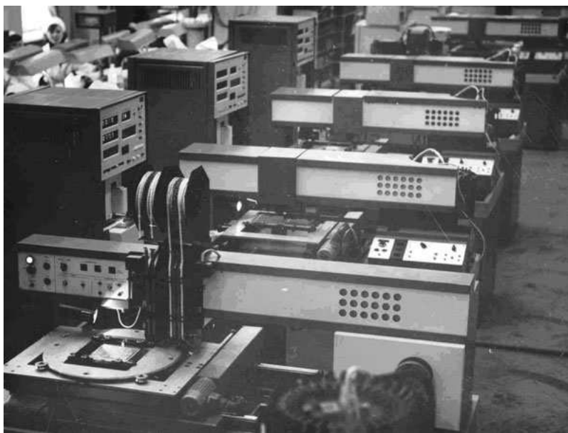
Рис. 9.18. Линия автоматической сборки модулей
