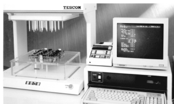
Рис. 5.48. Схема универсального стенда с программным управлением (а) и испытательная станция (б) для контроля электронных сборок
