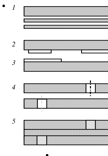
Рис. 5.28. Стадии формирования МПП методом попарного прессования: 1 – получение заготовок; 2 – получение рисунка на внутренних слоях; 3 – выполнение межслойных переходов; 4– прессование пакета
