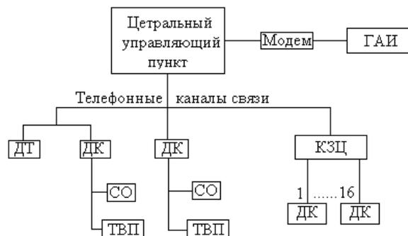
Рис. 1. Обобщенная структурная схема АСУДД третьего уровня
