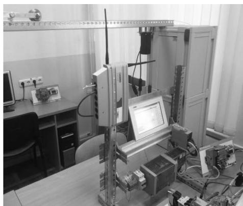
Рис. 1. Система управления процессом перемещения груза
