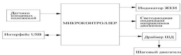
Рис.1 — Функциональная схема блока управления шаговым двигателем
