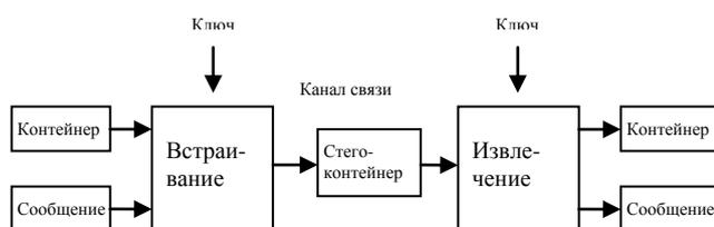
Рис. 1. Структурная схема типичной стеганосистемы
