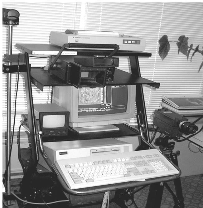
Рис.3.17. Тепловизионная система Thermovision 880
