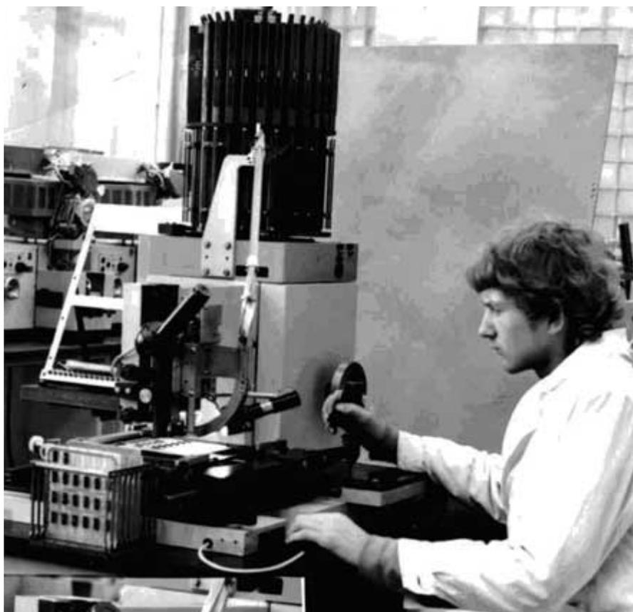
Рис. 2.6. Установка ИМС на полуавтомате с пантографом
