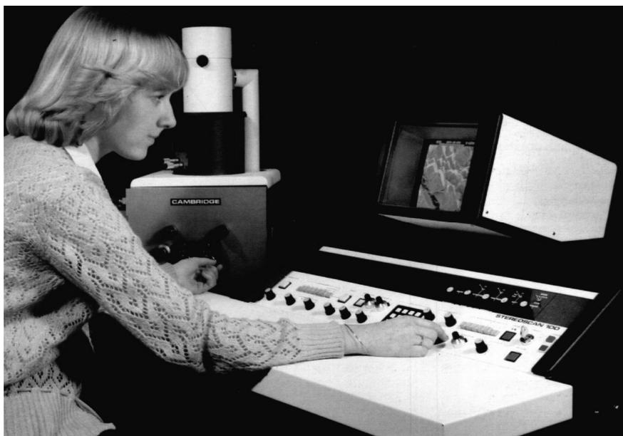
Рис. 3.19. Растровый электронный микроскоп Stereoscan-360
