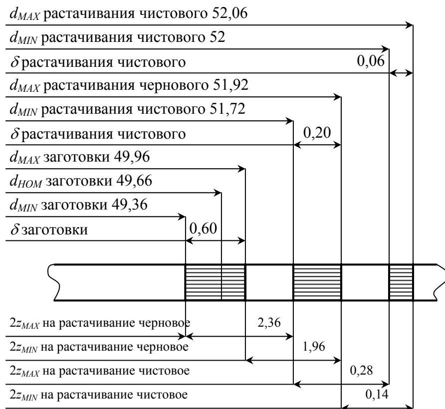
Рисунок 6.2. Схема расположения припусков и допусков на обработку отверстия корпуса подшипника
