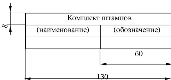
Рис.5.1. Оформление таблицы на сборочном чертеже штампа
