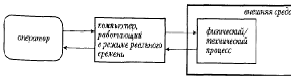
Рис. 4.15 Применение компьютера в управлении процессом [11]
