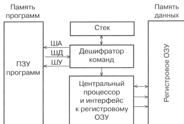
Рис. 4.11 Гарвардская архитектура микропроцессорной системы
