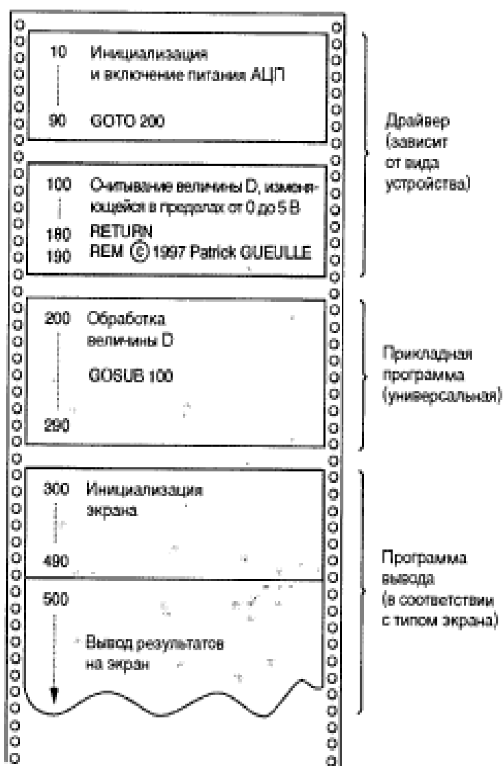
Рис. 5.6 Структура ПО виртуального измерительного комплекса [11]
