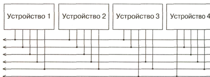
Рис. 4.7 Шинная структура связей [10]
