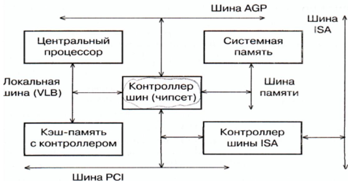
Рис. 4.25 Пример многошинной структуры [10]
