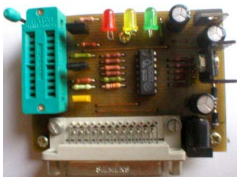
Рис. 4.12 Программатор для контроллеров PIC16X84 и PIC16F82X
