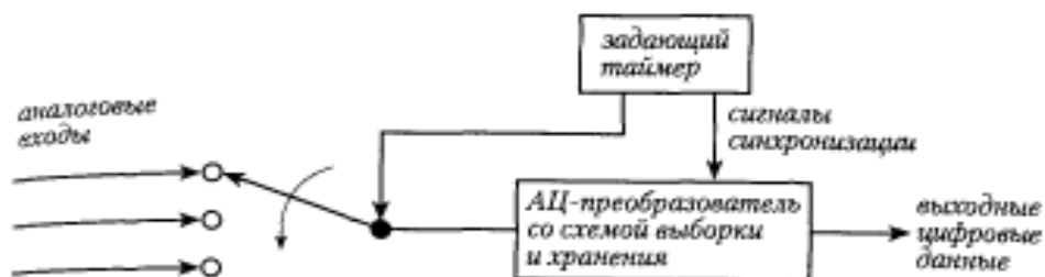
Рис. 4.21 Схема мультиплексирования в цифровых управляющих системах [11]
