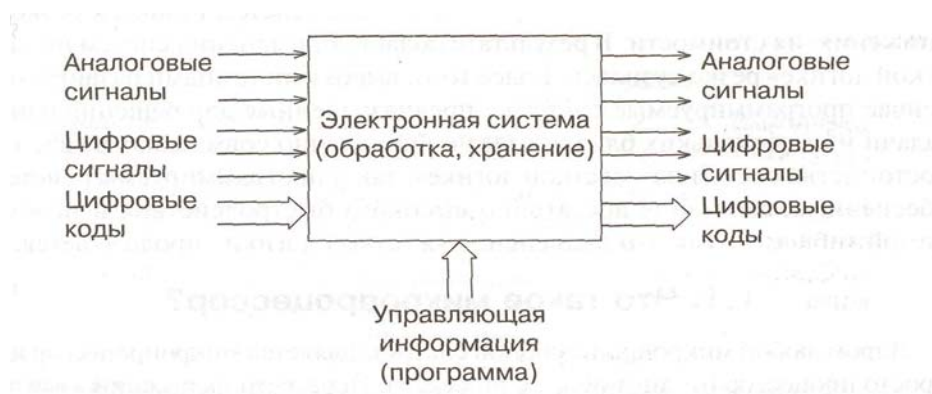
Рис. 4.2 Структура программируемой (универсальной) электронной системы [10]
