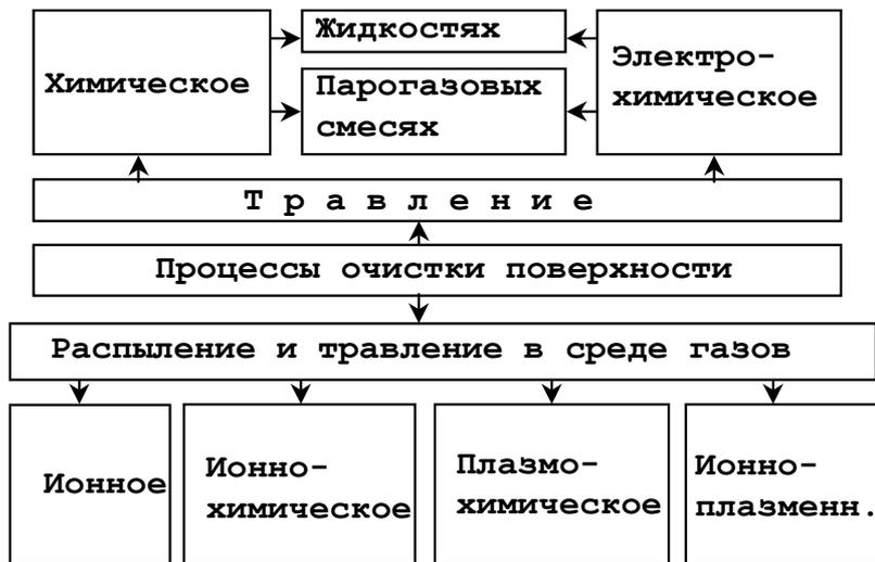
Рисунок 1.11 – Классификация методов очистки поверхности пластин
