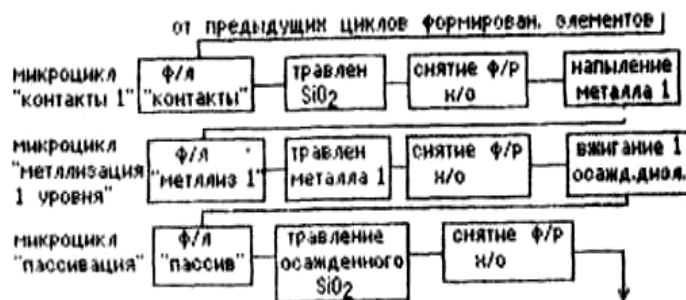
Рисунок 41 – Структурная схема технологического процесса формирования одноуровневой однослойной ТС
