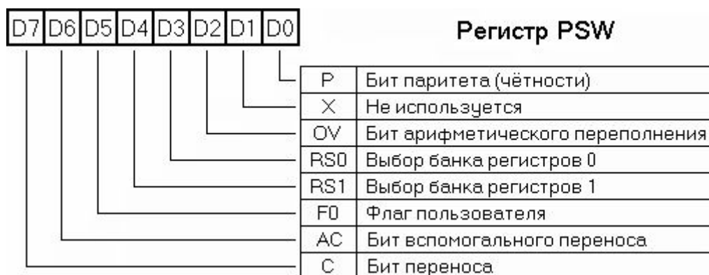
Рис. 36. Формат слова состояния PSW
