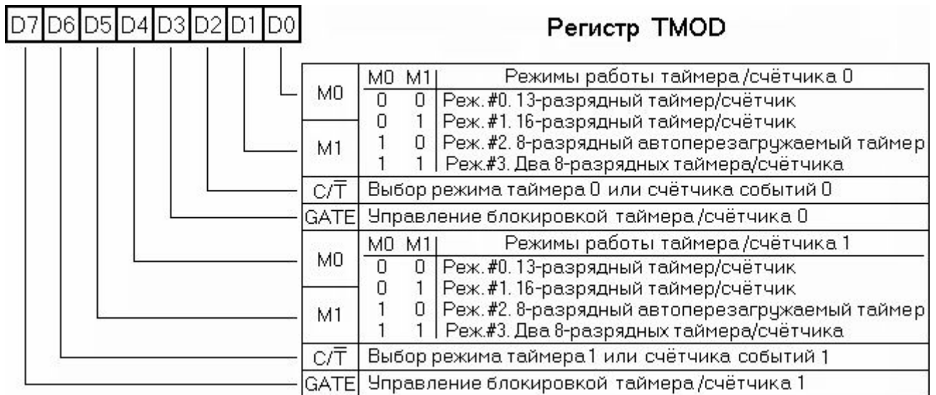
Рис. 22. Регистр режима таймеров/счётчиков TMOD
