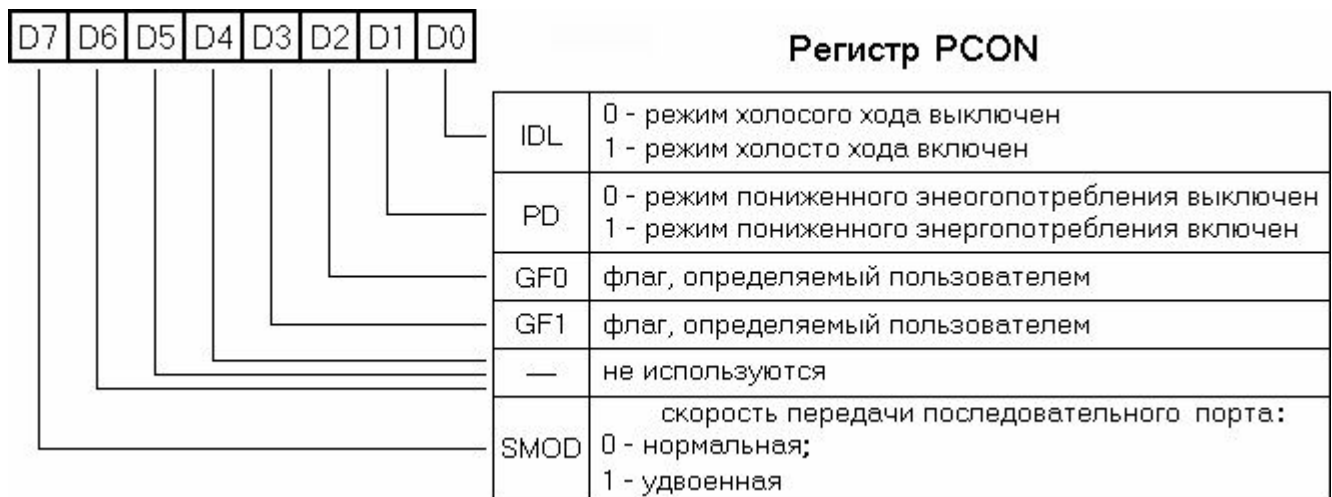
Рис. 32. Регистр управления мощностью PCON
