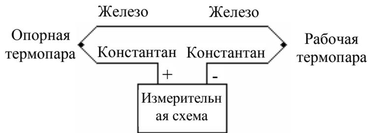
Рис.5.3. Схема включения термопары
