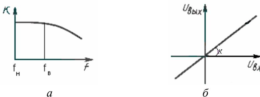
Рис. 6.1. Характеристики УПТ: а - частотная; б – амплитудная
