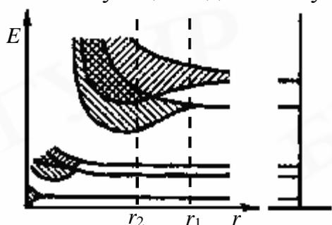
Рис. 30.8. Схема расщепления энергетических уровней в кристалле при сближении атомов
