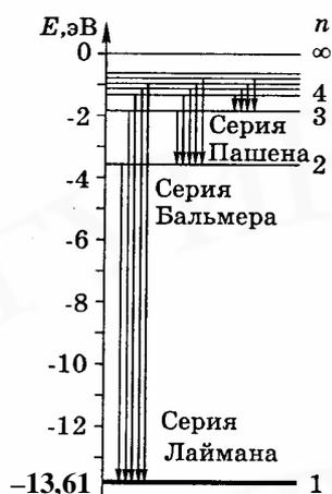
Рис. 28.4. Схема энергетических уровней для атома водорода
