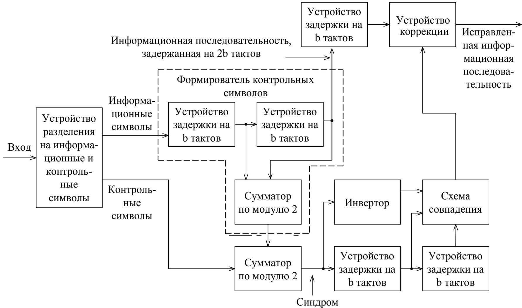
Рис. 2.9. Структурная схема декодера рекуррентного кода
