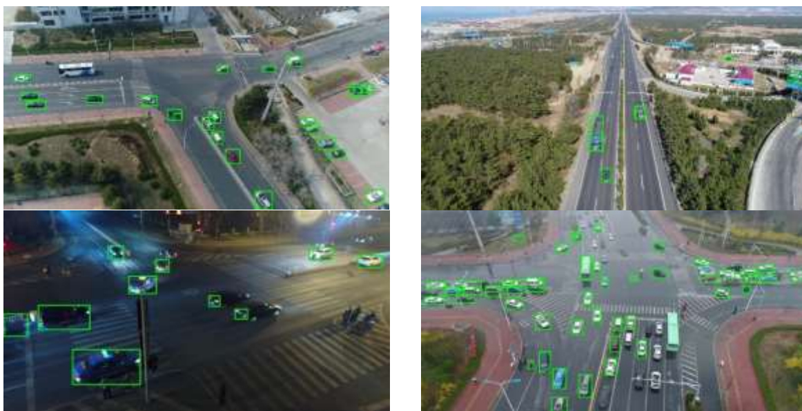
Рис. 3. Детекция объектов моделью YOLOv8n с предобработкой методом tiling
