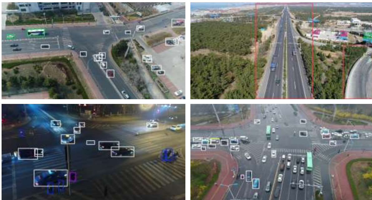
Рис. 2. Детекция объектов моделью YOLOv8n без предобработки
