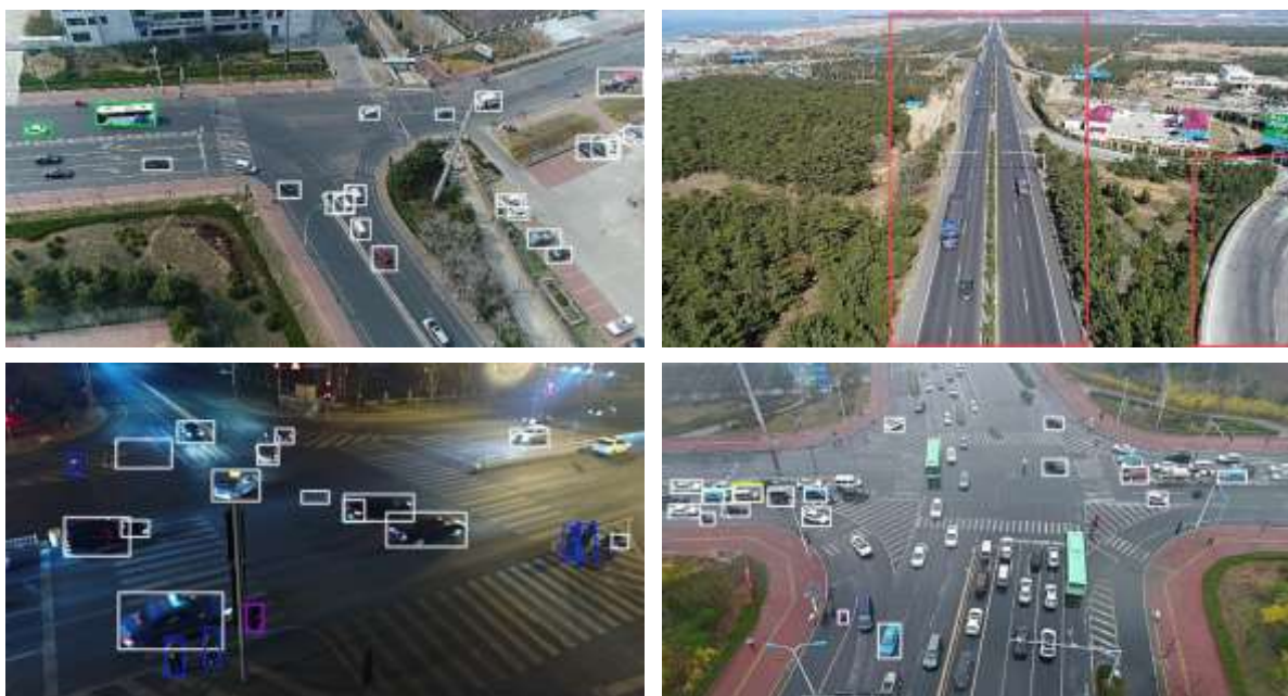
Рис. 5. Детекция объектов моделью YOLOv8n с предобработкой методом sharpening
