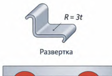
Рисунок 2 – Вариант Б – развертка с увеличенными радиусамигиба
