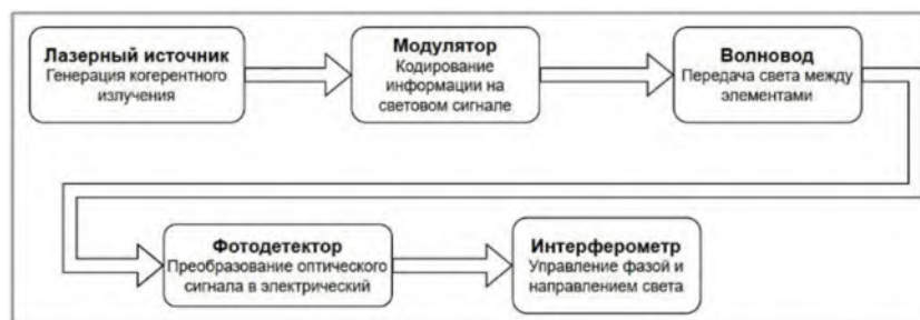
Рисунок 2 – Упрощенная структура фотонной интегральной схемы
