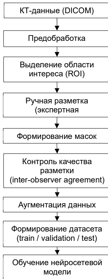
Рисунок 1 – Схема формирования обучающего набора данных для обучения нейросетевой модели сегментации
