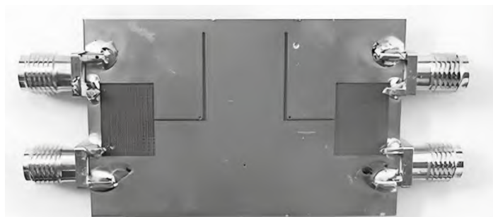
Рисунок 3 – Нижняя сторона платы фильтра, изготовленного с использованием метода дефектной структуры земли [8]
