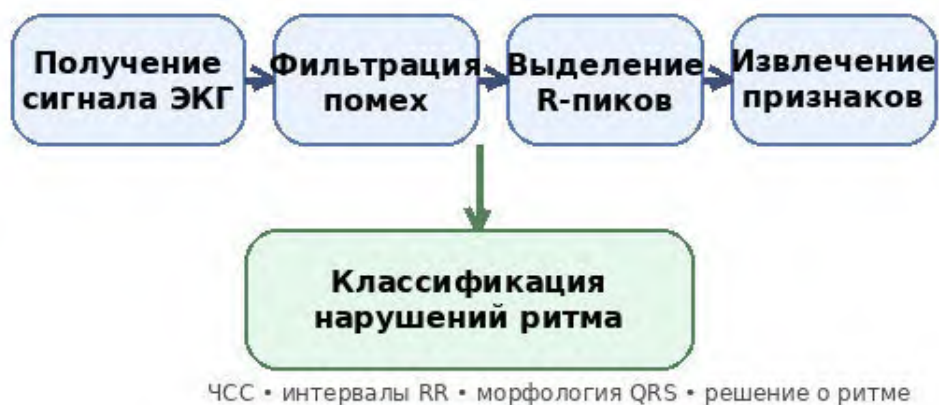
Рисунок 2 – Структурная схема алгоритма автоматизированного анализа ЭКГ
