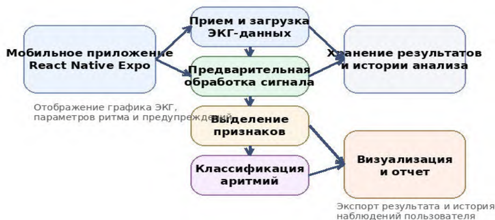
Рисунок 4 – Архитектура разработанного программного обеспечения анализа электрокардиограмм
