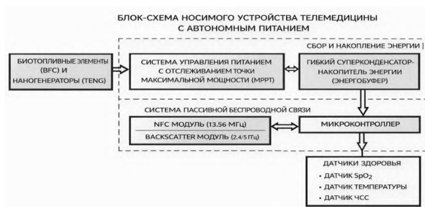
Рисунок 2 – Блок-схема усовершенствованной телемедицинской патч-системы с гибридным энергосбором
