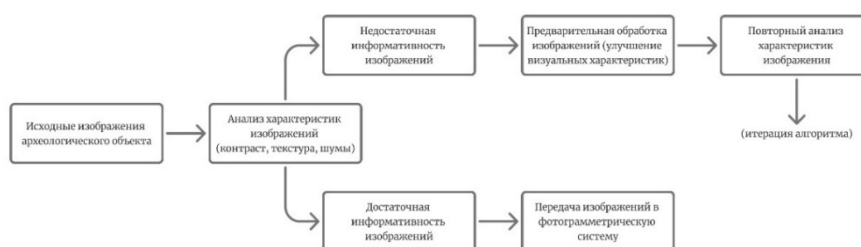
Рисунок 2 – Схема алгоритма предобработки изображений для повышения эффективности фотограмметрической реконструкции
