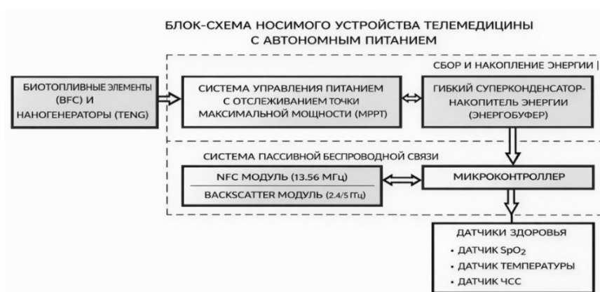
Рисунок 2 – Блок-схема усовершенствованной телемедицинской патч-системы с гибридным энергосбором
