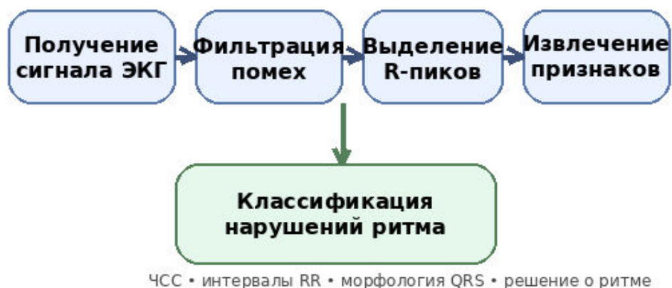
Рисунок 2 – Структурная схема алгоритма автоматизированного анализа ЭКГ
