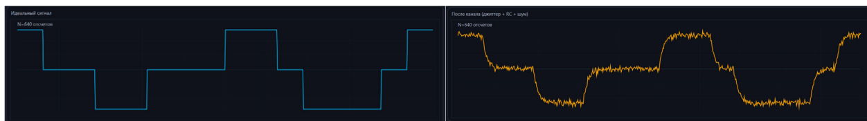
Рисунок 2 – Сравнение идеального сигнала и сигнала после канала (джиттер + RC -фильтрация + белый шум)
