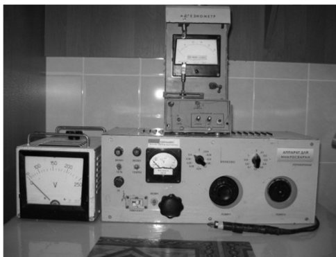
Рисунок 1 – Установка контактной микросварки НТ-1020
