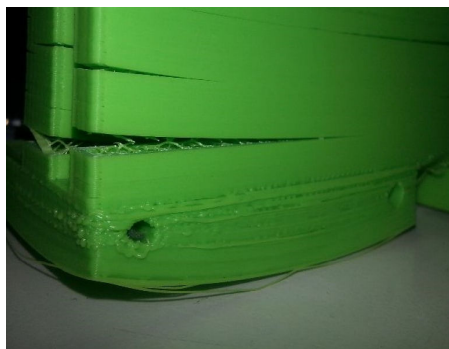
Рисунок 2 – Расслоение вдоль слоев
