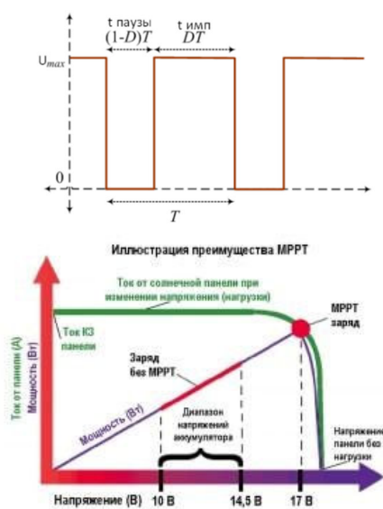
Рисунок 1 – График прямоугольных импульсов с меняющейся шириной импульса, где T – период ШИМ, t – длительность импульса
