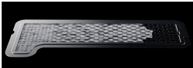
Рисунок 1– Паровая камера смартфона
