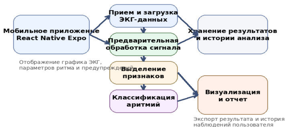
Рисунок 4 – Архитектура разработанного программного обеспечения анализа электрокардиограмм
