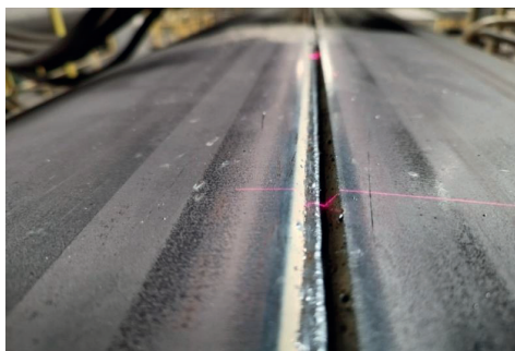
Рисунок 5 – Труба с продольным швом и поперечной линией от сканера
