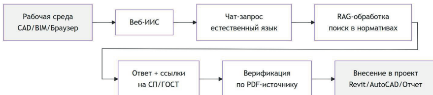
Рисунок 1 – Процессная модель взаимодействия проектировщика с ИИС
