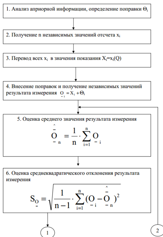
Рисунок 1 – Порядок выполнения многократного измерения при равноточечных значениях отсчета
