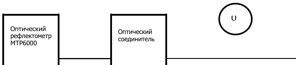
Рисунок 1 - Схема подключения оптического волокна к рефлектометру.
