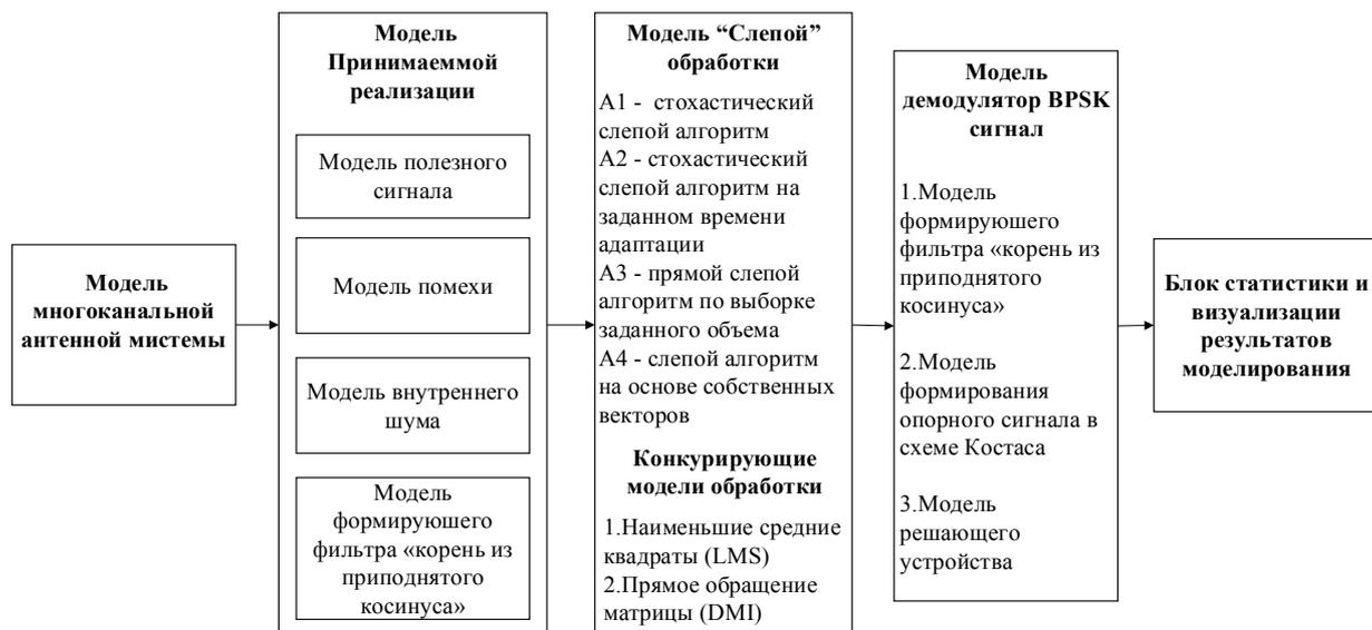
Рисунок 1 – Структура компьютерной модели приемника цифровой радиосвязи с многоканальной системой приема и «слепой» обработкой
