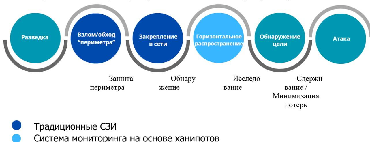
Рисунок 1 – Модель действия нарушителя
