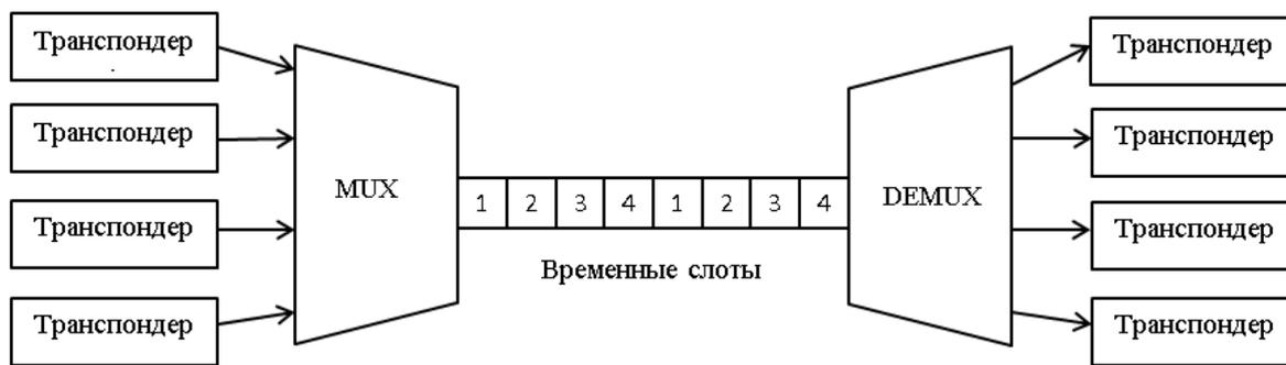
Рисунок 1 – Принцип передачи информационных каналов в системах TDM
