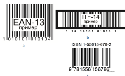
Рисунок 1 – Графическое изображение линейных штриховых кодов. а – EAN; б – ITF 14; в - ISBN
