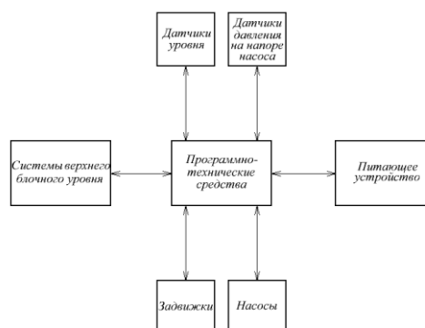
Рисунок 1 – Структурная схема системы подачи аммиака в теплоноситель
