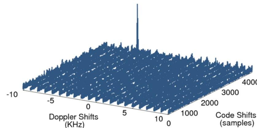
На частоту несущей влияет доплеровский эффект – изменения частоты вследствие движения спутника относительно приемника или приемника относительно спутника либо движение и приемника и спутника. Изменения частоты может достигать  $\pm 10$  кГц.
