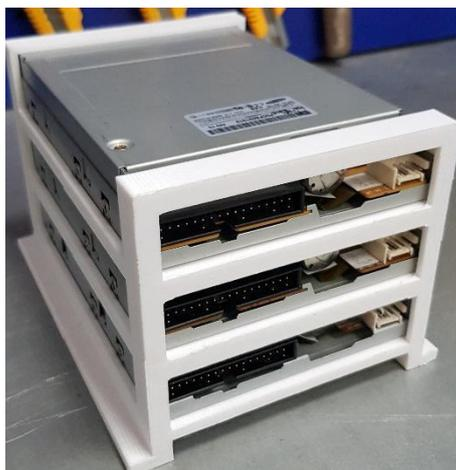
Рисунок 11 – Финальная версия стойки для флоппи-приводов
