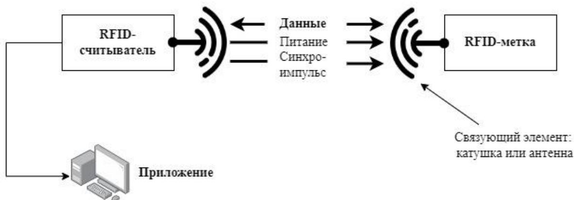
Рис.1 — Схема работы RFID-системы
