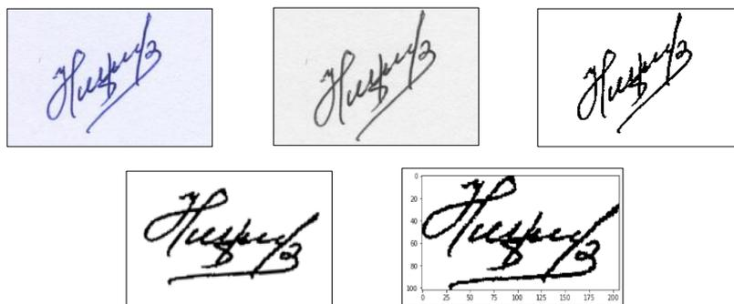
Рисунок 1 – Пример предварительной обработки ИЦП от цветного представления до бинарного фиксированного размера
