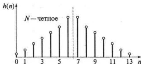
Рисунок 1 – Симметричная импульсная характеристика
