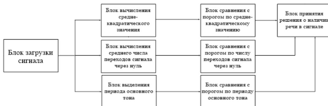
Рисунок 1 – Структурная схема модуля распознавания речи
