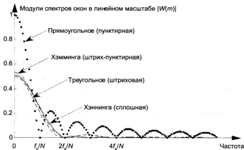
Рисунок 1 – Спектры различных оконных функций
