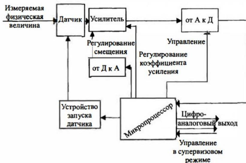
Рисунок 5 – Архитектура датчиков со встроенным микропроцессором
