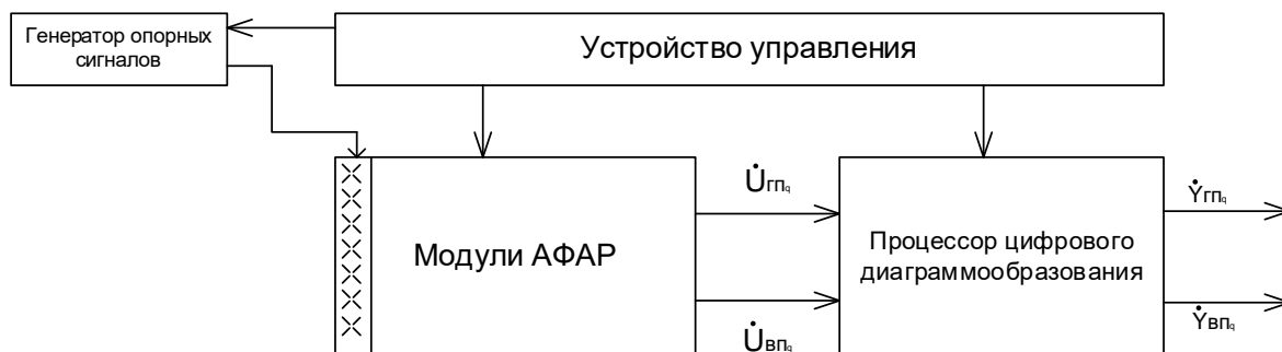
Рисунок 1 – Структурная схема модульной двухполяризационной АФАР
