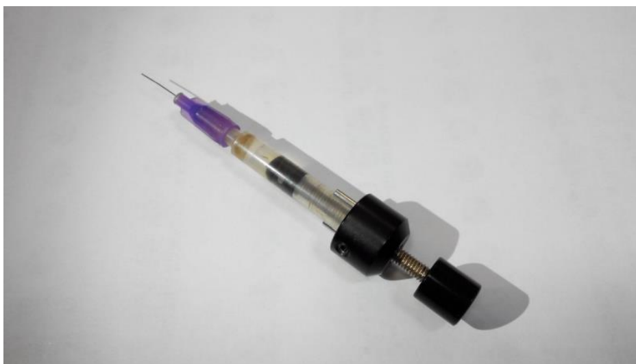
Рисунок 1 – Шприц-дозатор, формирующий капли объемом 2,5 мкл
