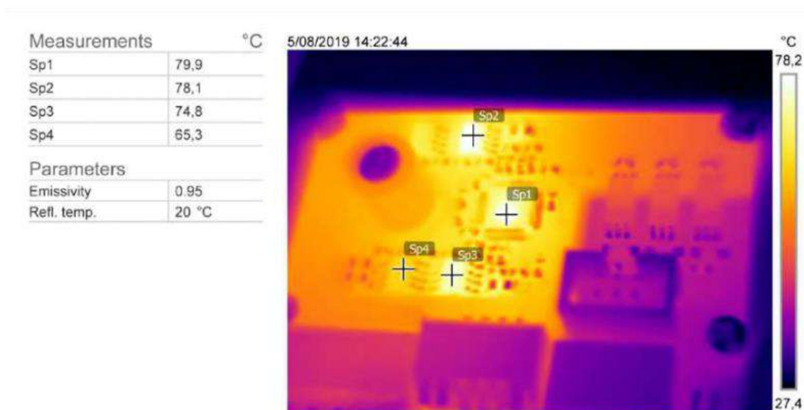
Рисунок 3 – Распределение тепловой энергии на плате с TMC2160-TA
