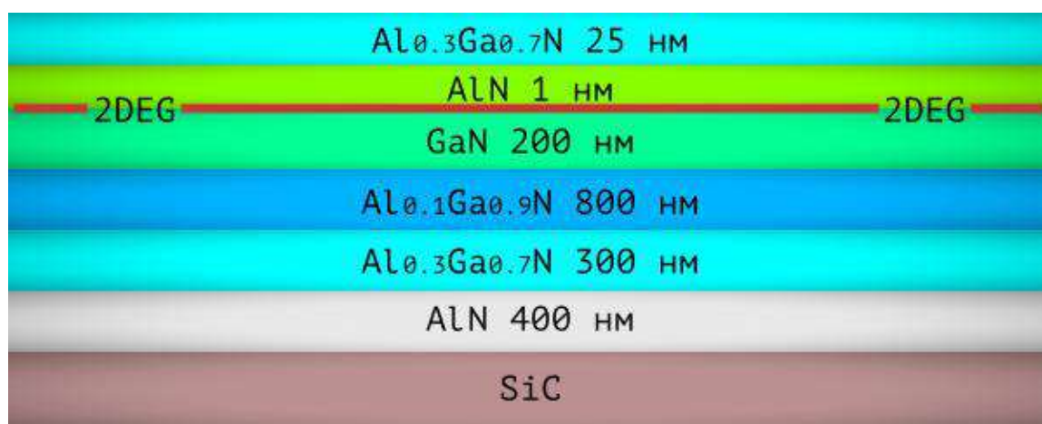
Рисунок 2 – Дизайн гетероструктуры на подложке из карбида кремния
