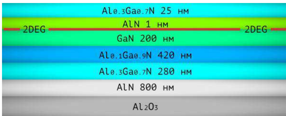
Рисунок 1 – Дизайн гетероструктуры на подложке из сапфира
