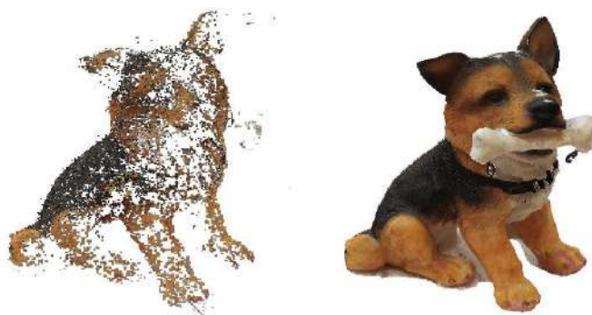
Рисунок 1 - Построение облака точек и текстуры модели
