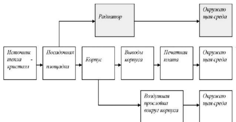
Рисунок 2. – Пути отвода тепла в ИМС или полупроводниковом приборе
