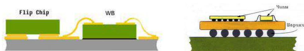
Рисунок 1 – Схема монтажа кристалла по Flip Chip, WB и SiP технологий
