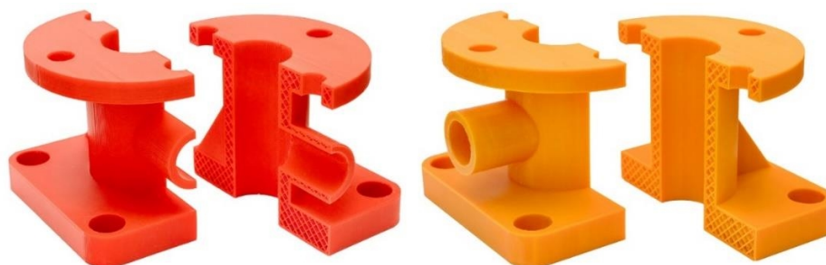
Рисунок 2 – Учебная модель корпуса, распечатанного на 3D-принтере
