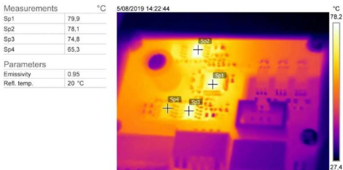
Рисунок 3 – Распределение тепловой энергии на плате с TMC2160-TA
