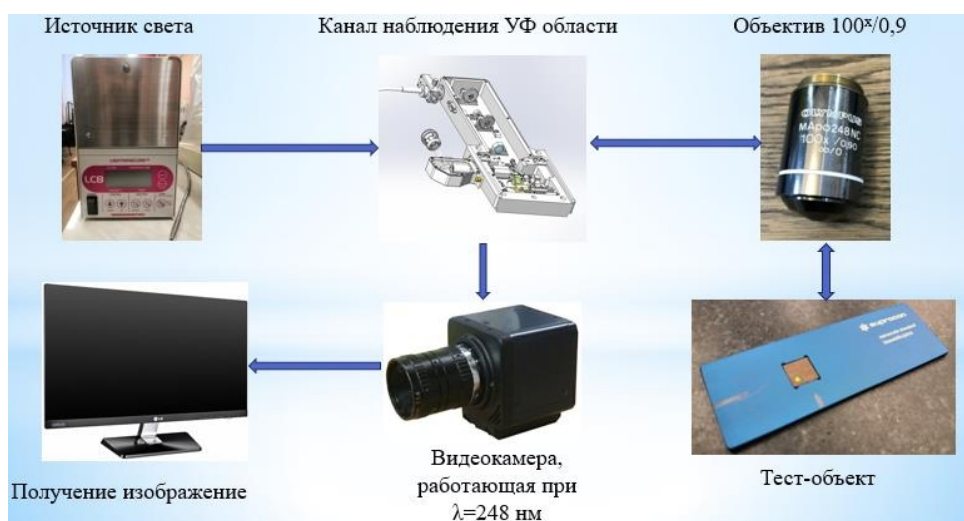
Рисунок 2 – Системообразующие элементы для исследования разрешающей способности ГУФ микроскопа
