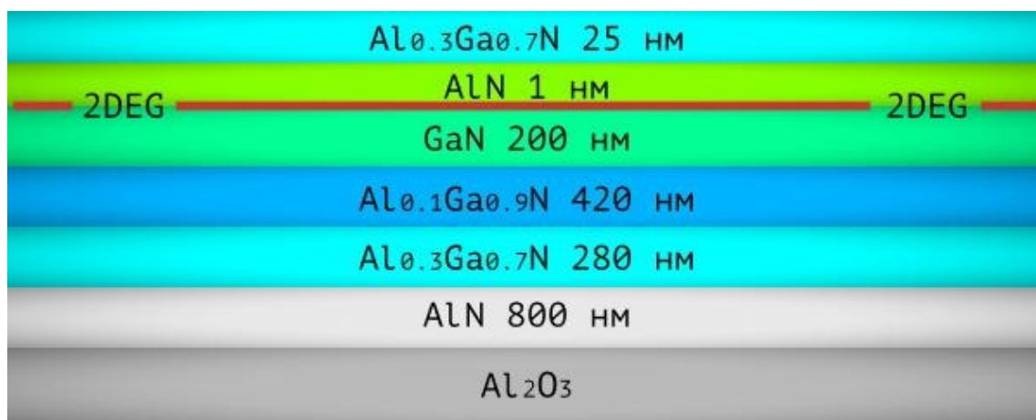
Рисунок 1 – Дизайн гетероструктуры на подложке из сапфира
