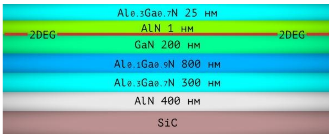
Рисунок 2 – Дизайн гетероструктуры на подложке из карбида кремния
