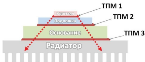
Рисунок 2 – Распределение тепла и основные теплопроводящие уровни
