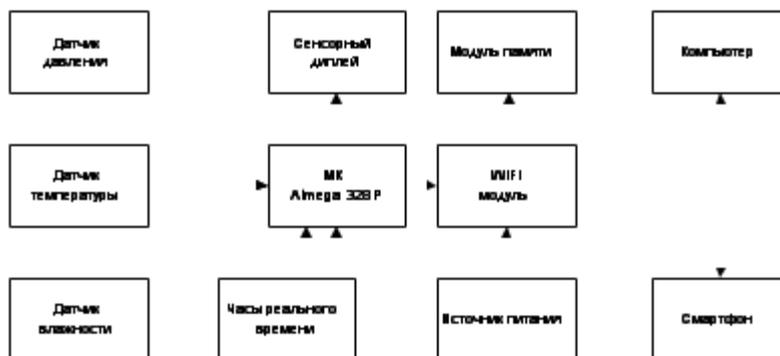
Рис.1 – Схема устройства автоматического контроля параметров внешней среды
