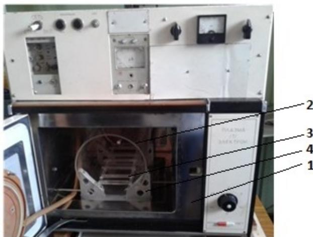
Рис.1 – СВЧ плазмотрон резонаторного типа
