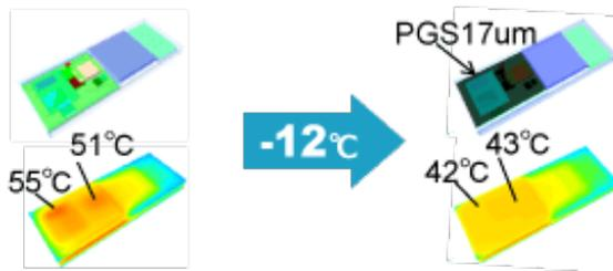
Рис. 3 - Использование PGS-пленок позволяет добиваться равномерного распределения тепла
