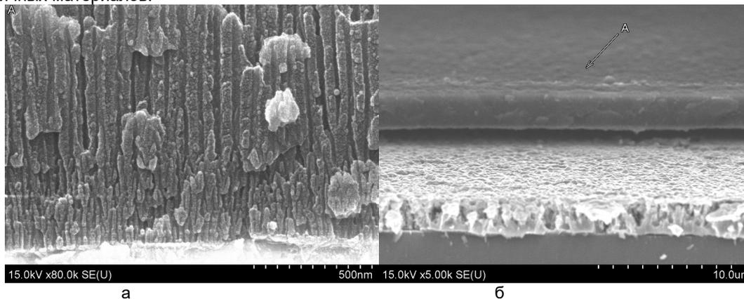
Рис. 2 – Поперечные сколы тонкоплёночной системы Al-V-Cu в различных точках кинетики анодирования
