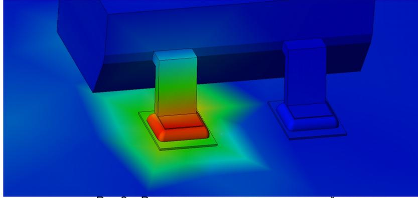
Рис.2 – Распространение тепловых полей на плате
