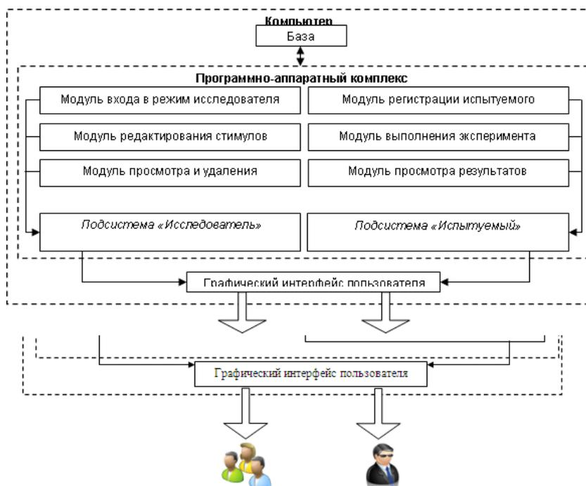
Рисунок 1 – Структурная схема системы
