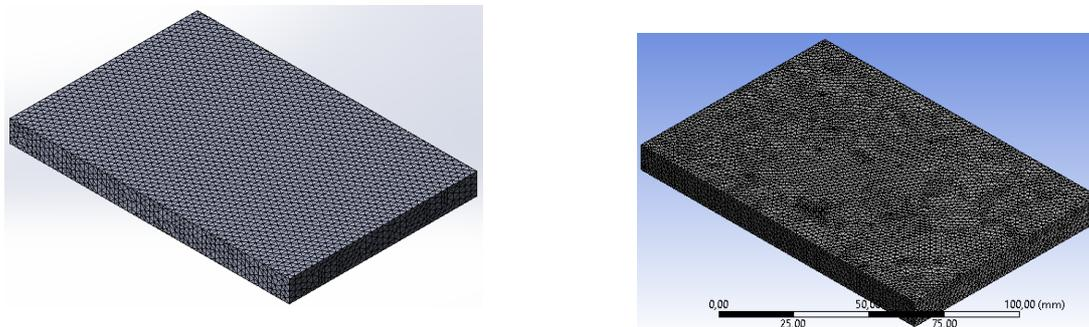
Рисунок 1 – Отличие сеток слева-направо: SolidWorks, ANSYS
