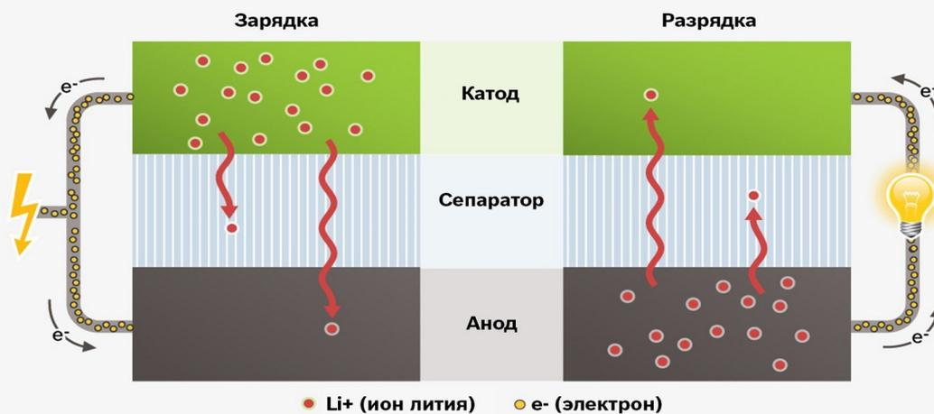
Рис. – Схема работы литий-ионного аккумулятора
