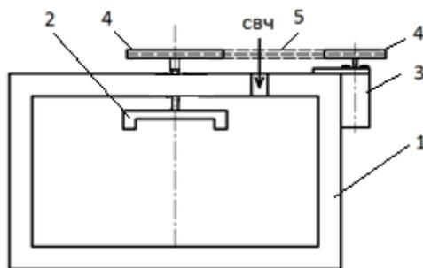
1 – резонаторная камера; 2 – диссектор;
