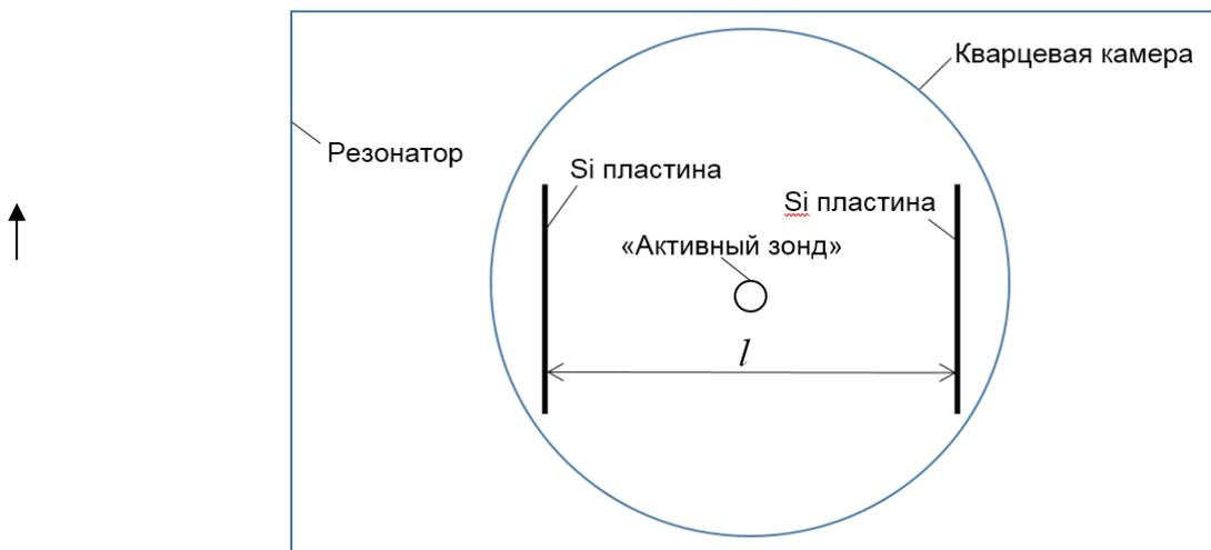
Рис. 1 - Схематичное изображение размещения пластин относительно «активного зонда» при измерении влияния расстояния между пластинами в призматическом объеме на величину СВЧ энергии между ними
