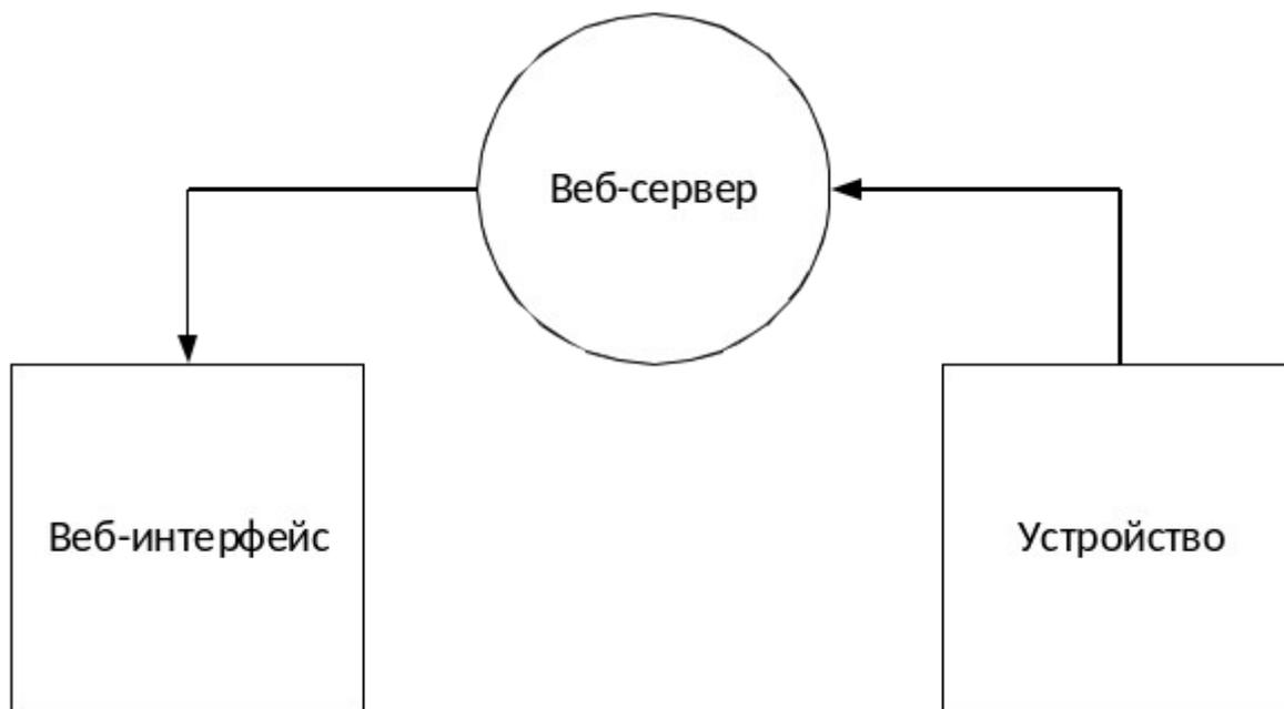
Рисунок 1 – Структурное представление взаимодействия компонент системы.
