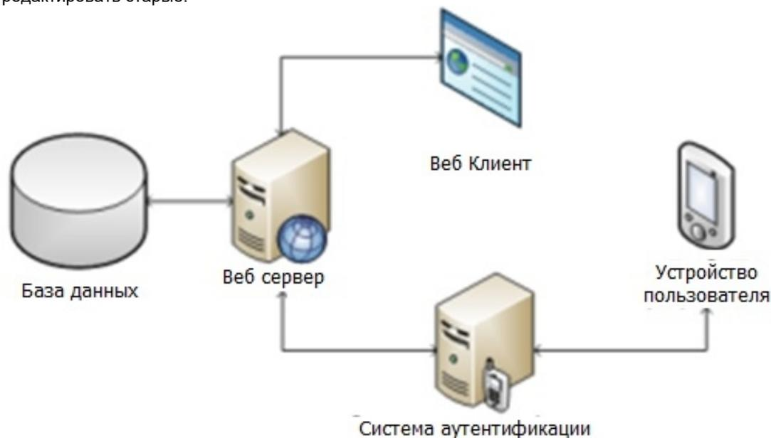
Рисунок 1. Архитектура системы
