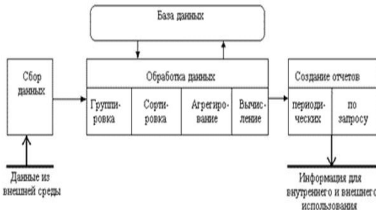
Рисунок 1. – Алгоритм обработки информации по средством базы данных
