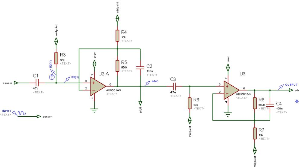
Рис.3 – Схема усилителя сигнала
