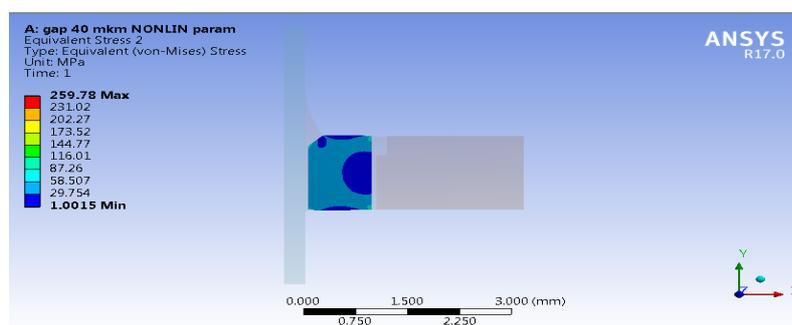
Рис. 3 – Эпюра напряжений для керамической детали в МКУ
