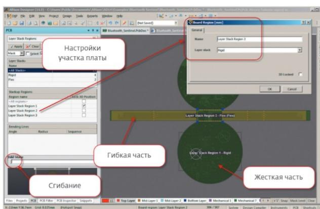
Рисунок 3 – Управление параметрами различных участков платы
