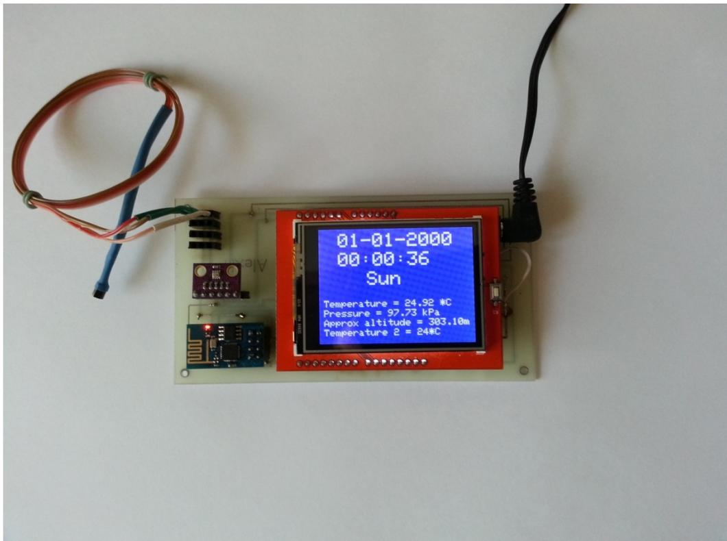
Рис.3 – цифровая автоматическая станция мониторинга погодных условий
