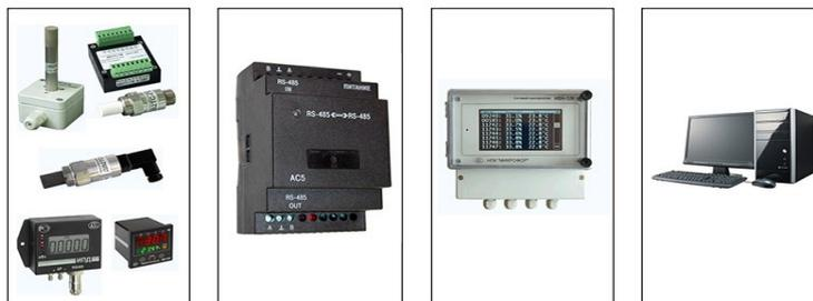
Рис. 1 - Структура системы контроля микроклимата и других параметров технологических сред
