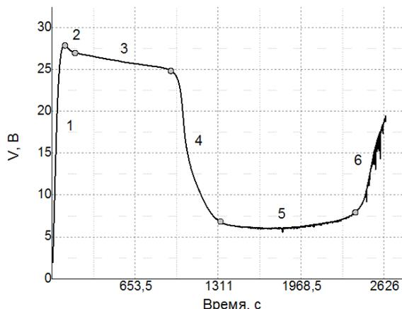
Рис. 1 – Кинетика анодирования тонкоплёночной системы Al-V-Cu
