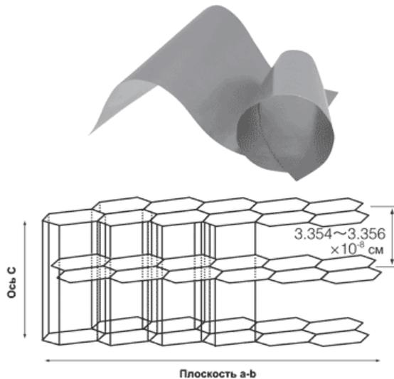
Рис. 1 - Структура графитовых пленок PGS
