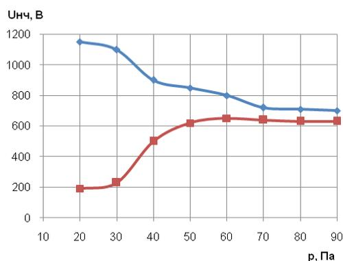
◆ – значение амплитуды НЧ импульсов на разрядном промежутке без СВЧ разряда;
