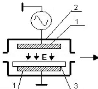
Рис. 1 – Схема рабочей области установки ВЧЕ-травления.
