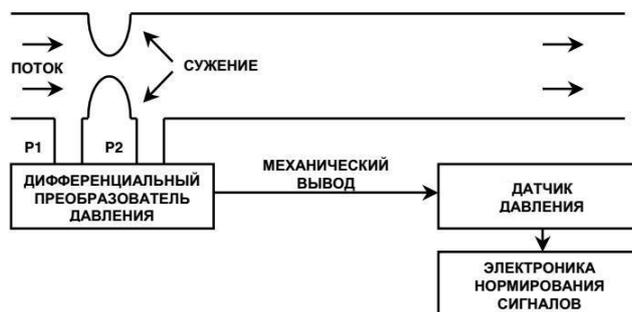
Рис. 1 – Схема датчика потока
