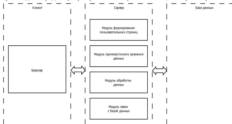
Рисунок 10 — Структурная схема приложения
