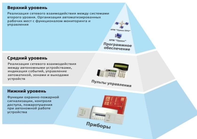
Рисунок 1. – Модель построения интегрированной системы безопасности
