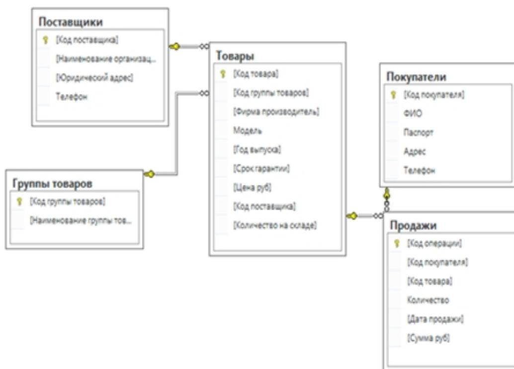
Рисунок 1 – Схема базы данных магазина бытовой техники
