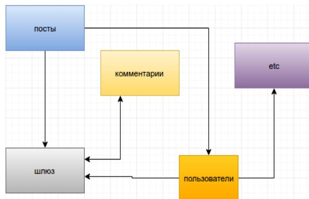
Рис. 2 – Микросервисная архитектура
