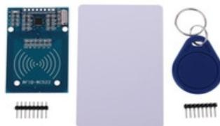
Рис. 2 - плата расширения RFID RC522 и RFID-метки
