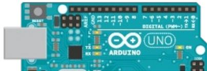
Рис. 1 – Внешний вид платы Arduino Uno
