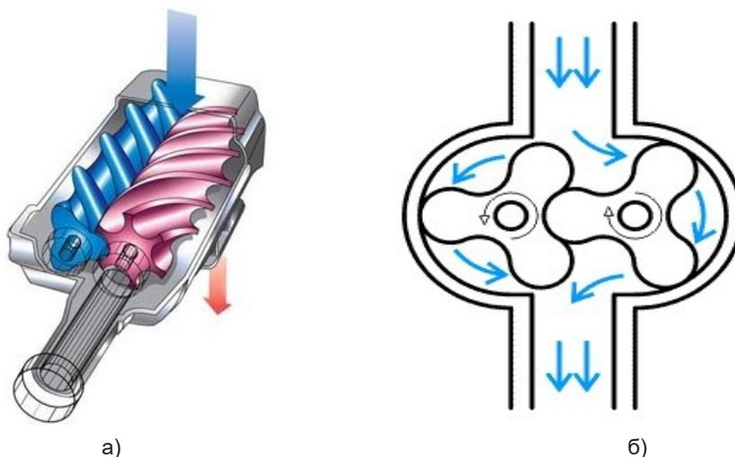
Рис. 2 –Механический нагнетатель воздуха: а) вид, б)схема работы
