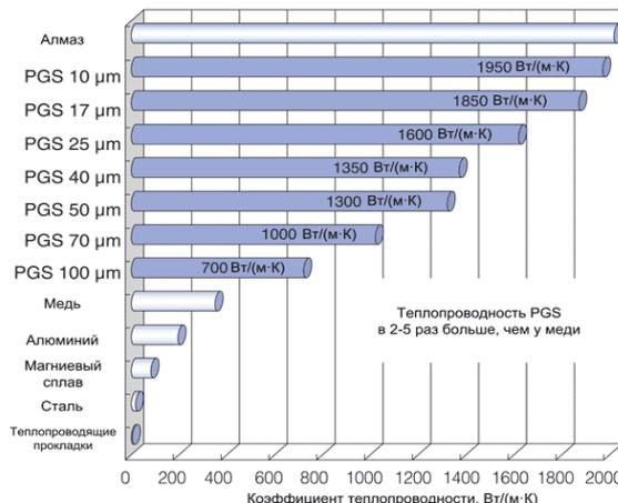
Рис. 2 - Сравнение теплопроводностей различных материалов
