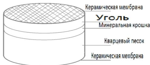
Рис. 3 – Устройство самодельного угольного фильтра
