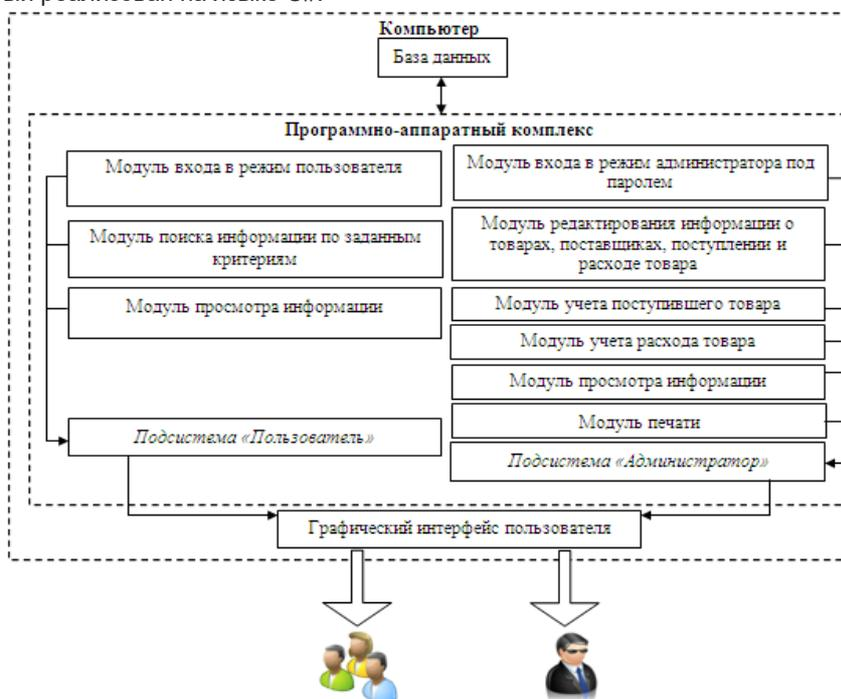
Рисунок 1 – Структурная схема программы
