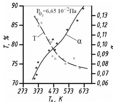
Рис.3 – Зависимость пропускания и поглощения от температуры подложки
