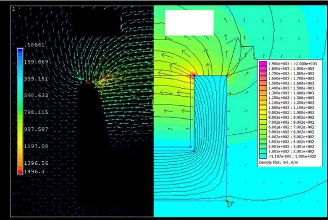
Рисунок 4 – Внешний вид распределения вектора напряженности магнитного поля  $H$  в программах ANSYS (а) и FEMM (б)
