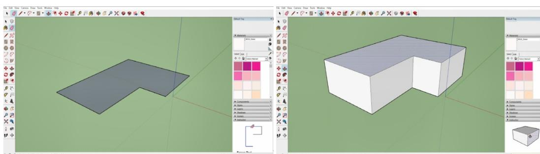
Рис. 1 – До и после использования инструмента Push/Pull
