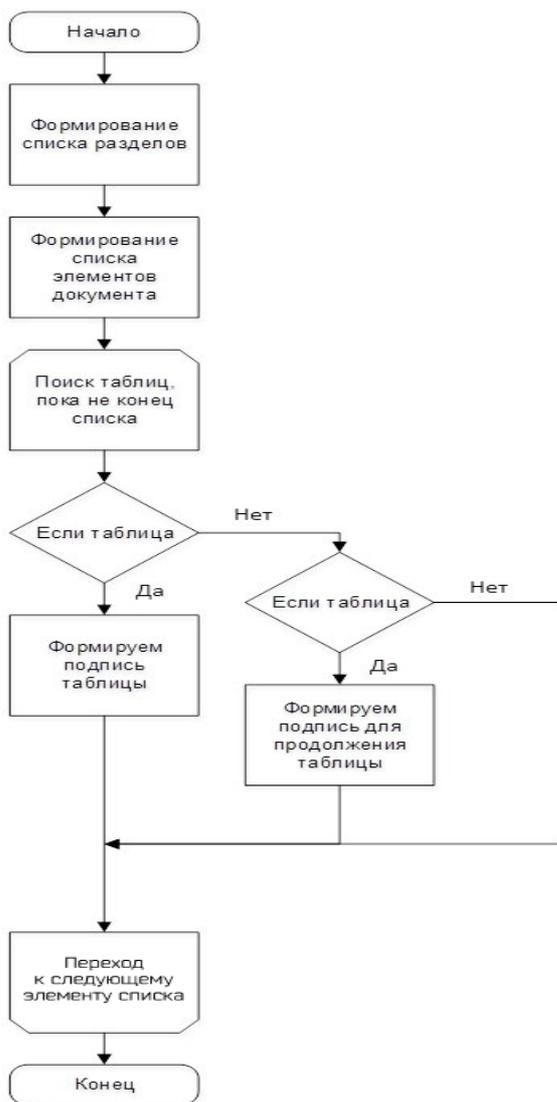
Рисунок 9 – Блок-схема алгоритма форматирования таблицы и подписи
