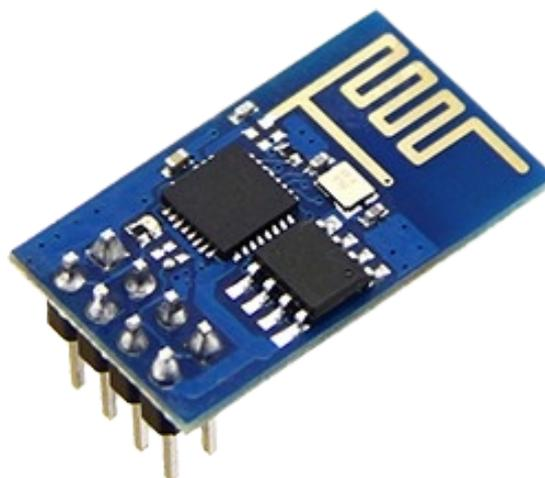
Рис. 2 – Модуль ESP8266
