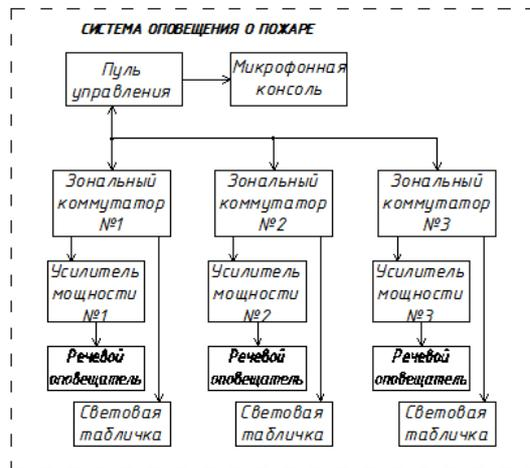
Рисунок 2 – Структурная схема системы оповещения о пожаре
