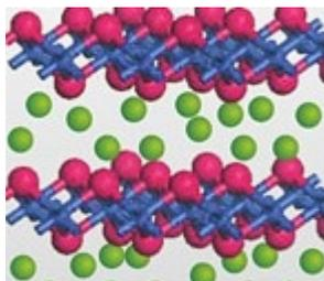
Рис. 1 — Углеродная матрица и ионы лития
