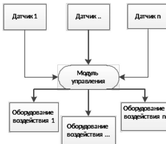
Рис. 1 – Функциональная схема работы информационной системы
