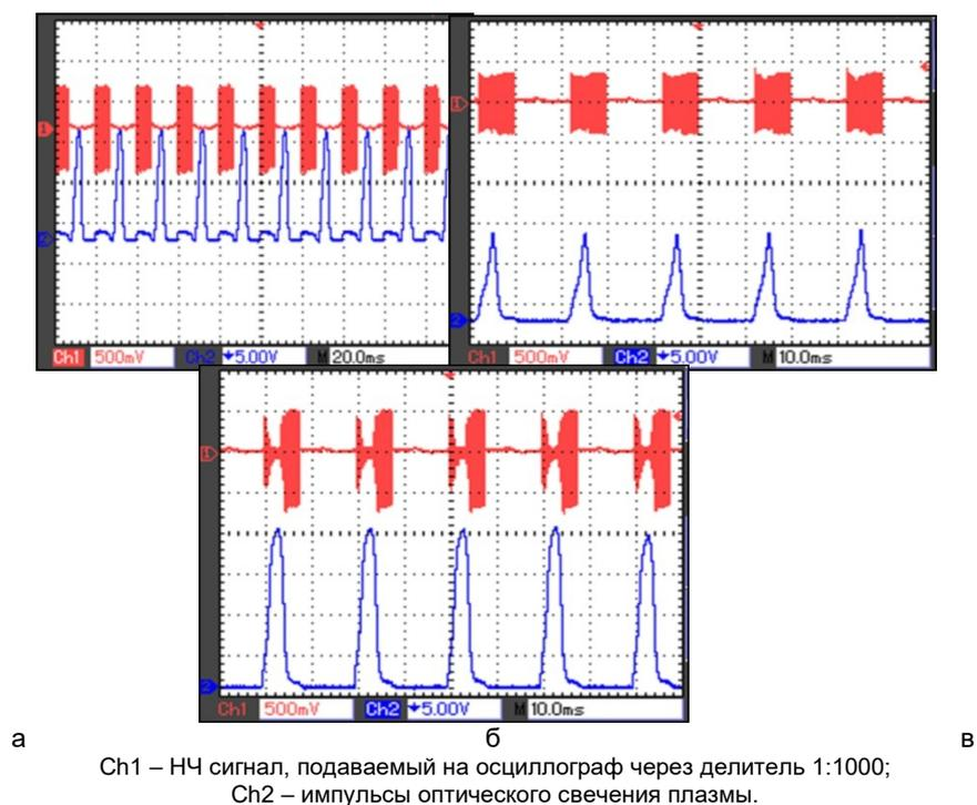
Рис.1 – Варианты временного соотношения импульсов СВЧ и НЧ относительно друг друга:
