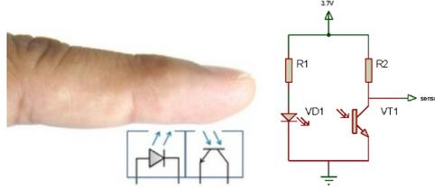
Рис.2 – Схема оптического датчика
