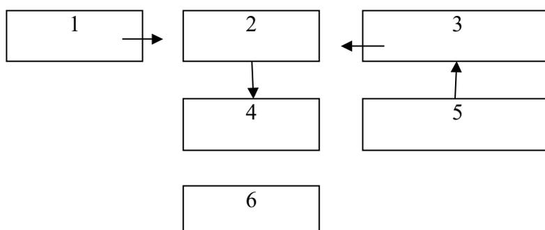
1 – высоковольтный регулируемый источник питания; 2 – электроразрядная система;
