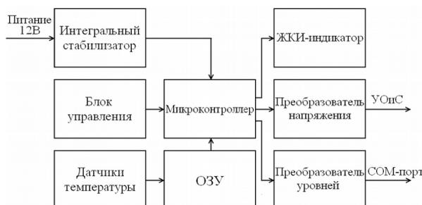
Рис. 1 – Структурная схема устройства дистанционного контроля температуры
