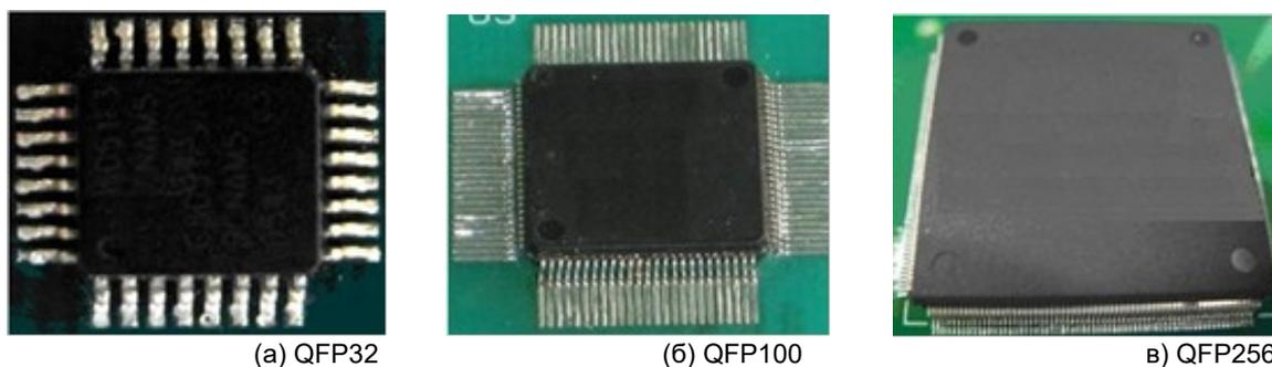
Рис.2 – QFP устройства припаянные диодной лазерной системой
