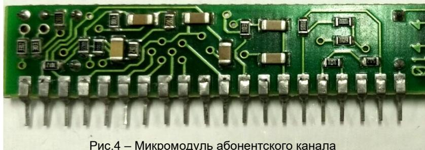
Рис.4 – Микромодуль абонентского канала
