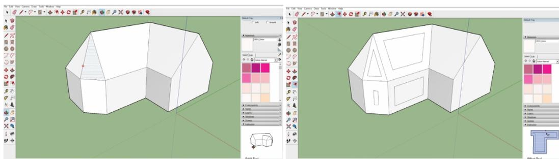
Рис. 3 – До и после использования инструмента Offset
