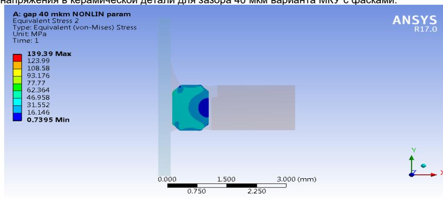
Рис.4 – Эпюра напряжений для керамической детали в МКУ с фасками
