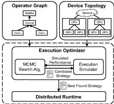
Рис. 1 – Структура FlexFlow
