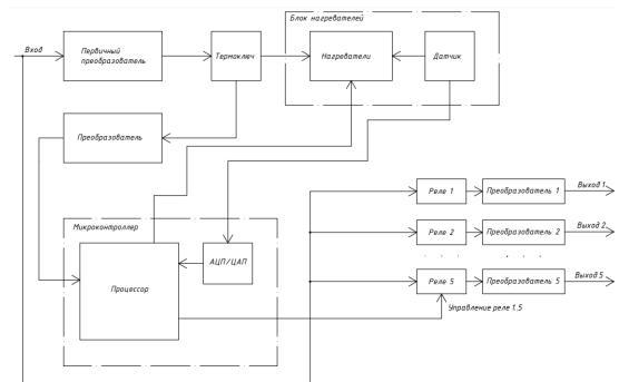
Рис. 1 – Структурная схема модуля вторичного электропитания бортовых систем
