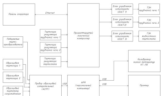
Рис. 1 – Структурная схема автоматизированной системы поверки термопреобразователей
