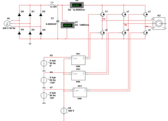
Рис. 2 – Схема электропривода, смоделированного в среде Simulink
