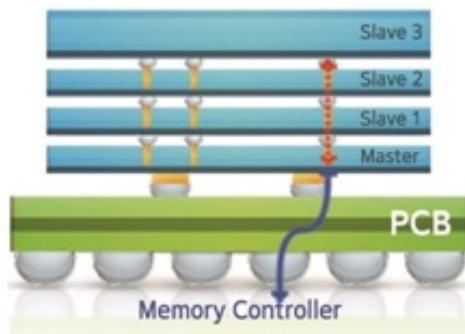
Рис. 1 – Реализация 3D-модуля по технологии TSV
