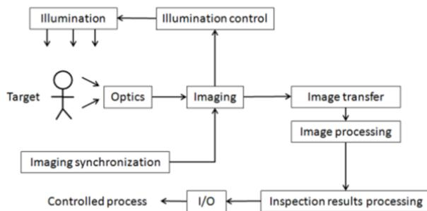
Рис. 2 – Базовая структура системы технического зрения
