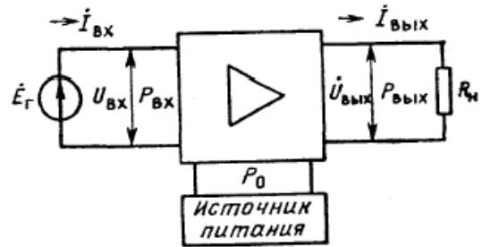
Рис. 1 – Структурная схема усилителя мощности
