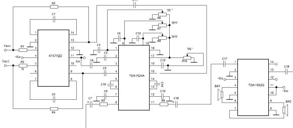
Рис. 3 – Принципиальная схема усилителя мощности
