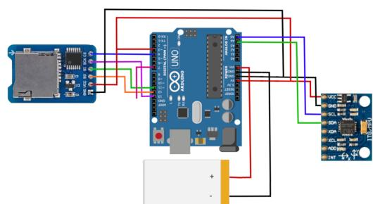
Рис. 2 – Схема портативного устройства для регистрации трепора
