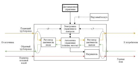
Рис. 1 – Структурная схема системы управления
