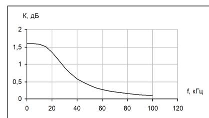
Рис. 4 – Зависимость коэффициента усиления усилителя мощности от частоты
