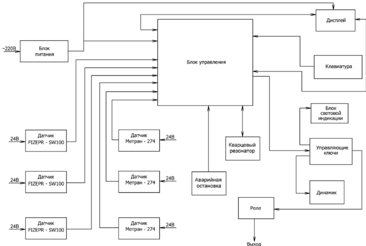
Рис. 1 – Функциональная схема модуля управления зерносушилкой
