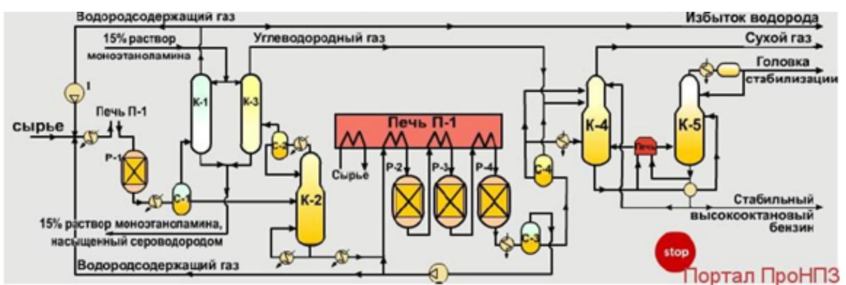
Рис. 1 – Рис. 1 Принципиальная схема установки каталитического риформинга
