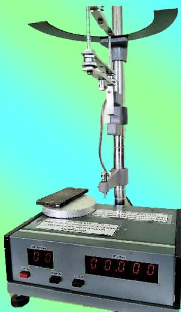
2м.4 Измерение момента инерции махового колеса и силы трения в опоре
