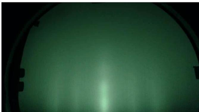
Рисунок 1 – Типичная дифрактограмма графена полученная методом RHEED
