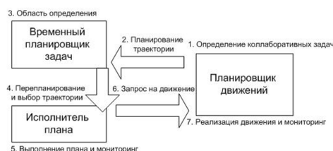
Рис. 1 – Схема интеграции процессов планирования траектории и перепланирования во время выполнения
