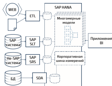
Рис. 2 – Архитектура корпоративного хранилища данных с использованием SAP HANA
